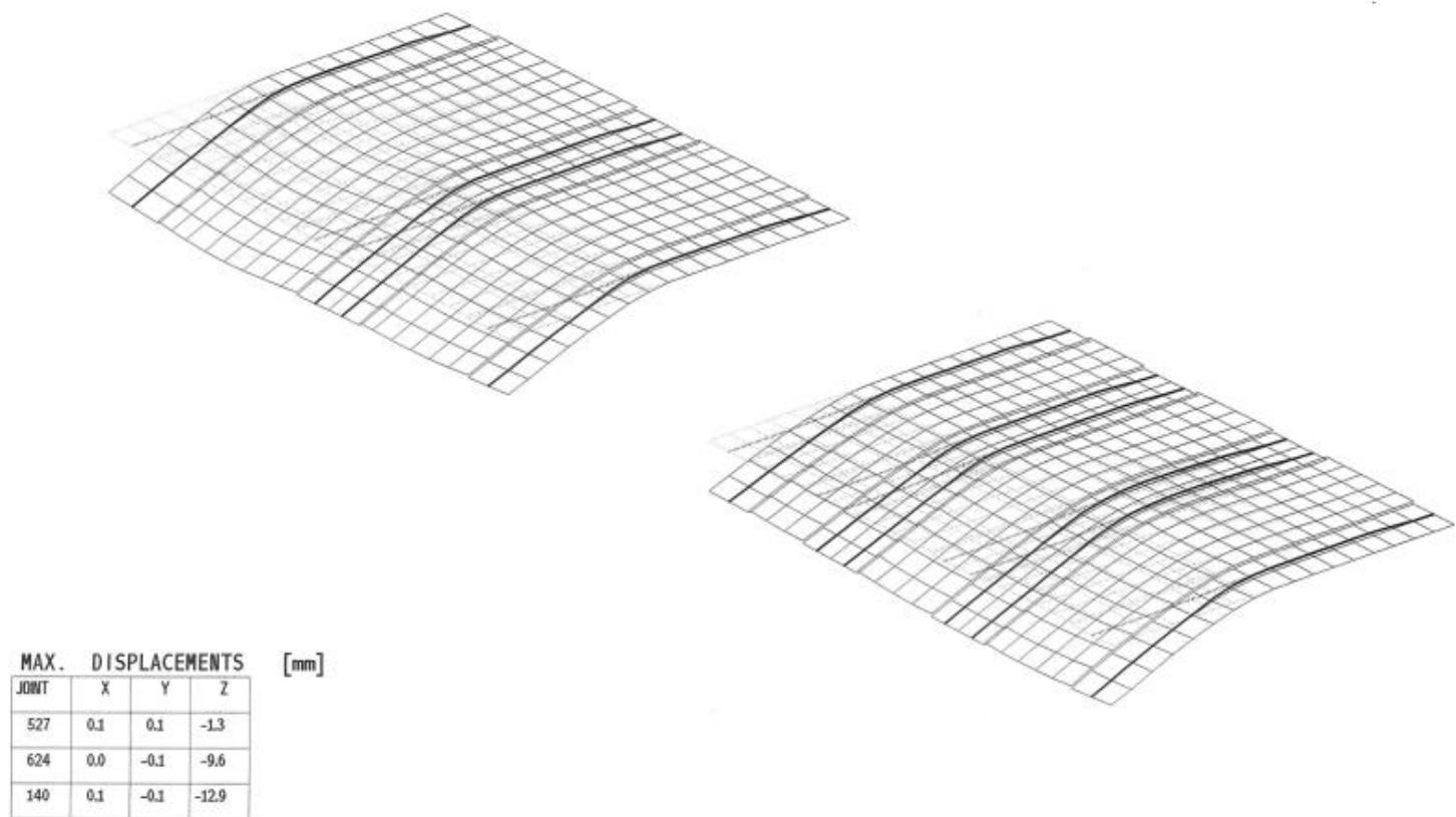
Slika 24: Oblik izvijanja ploče kod opterećenja Q
