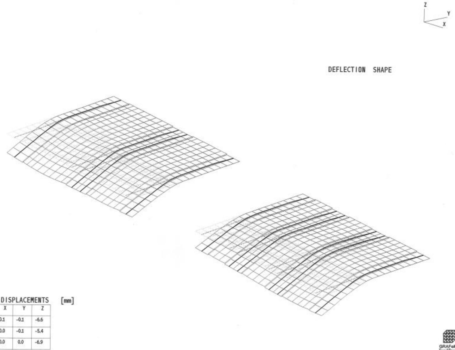
Slika 20: Oblik izvijanja ploče za stalno opterećenje G
