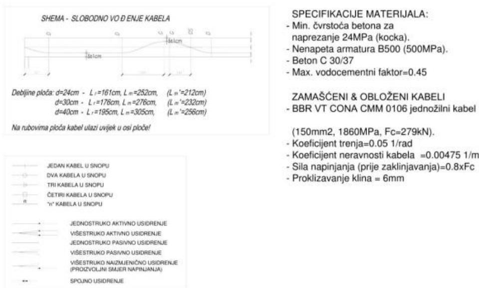
Slika 16: Parametri korišteni kod prednaprezanja
