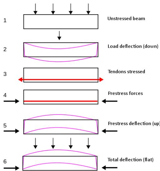
Slika 6: Princip prednapregnutog betona
