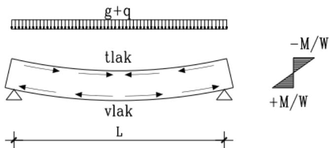
Slika 4: Dijagram normalnih naprezanja u betonskoj gredi
