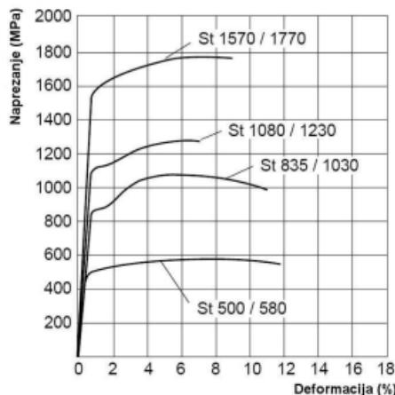
Slika 15: Radni dijagrami armature i čelika za prednapinjanje
