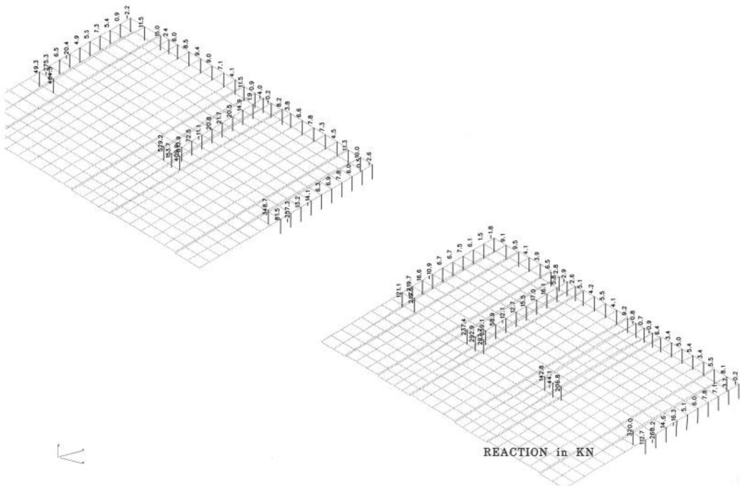
Slika 27: Reakcije u konzolama za opterećenja  $Q$ , kN
