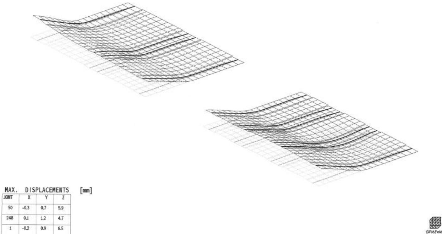
Slika 22: Oblik izvijanja ploče kod prednapinjanja P
