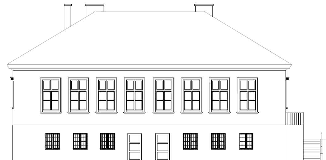
Slika 12. Planirano stanje - južno pročelje [6]
