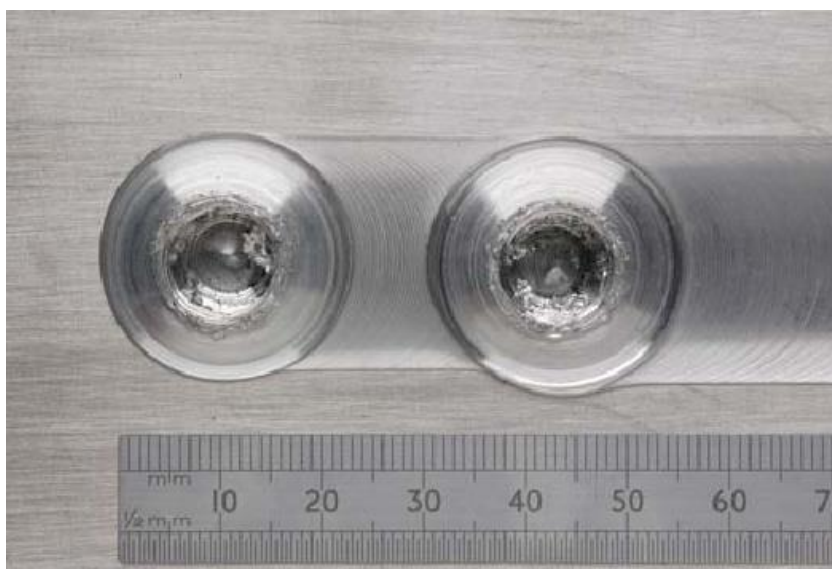
Slika 2.9 Provrt („ključanica“) na kraju zavarenog spoja [16]
