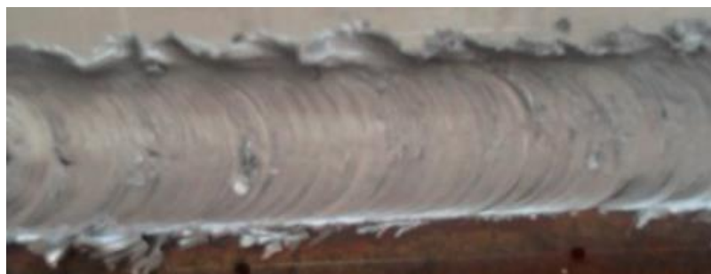
Slika 2.12 Prekomjerno istiskivanje i prekomjerno udubljenje lica zavara [22]
