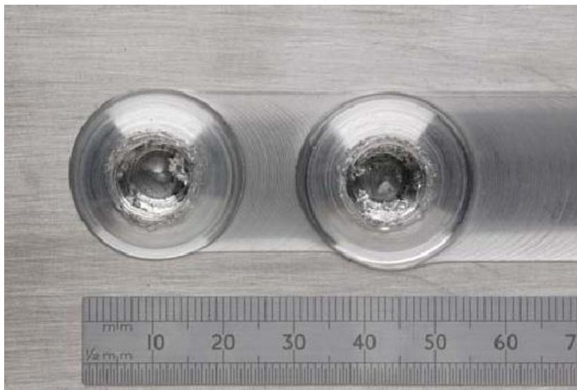
Slika 2.9 Provrt („ključanica“) na kraju zavarenog spoja [16]
