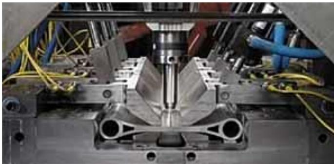
*Slika 2.28 Zavarivanje trenjem rotirajućim alatom dijelova suspenzije vozila [47]*
