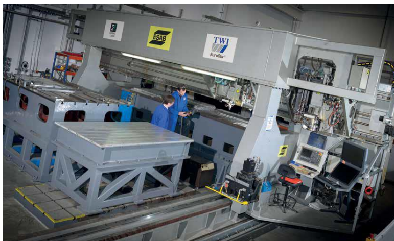
Slika 2.30 Specijalno izrađen SuperStir sustav za provođenje istraživanja na TWI-u [51]
