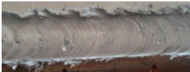
Slika 2.12 Prekomjerno istiskivanje i prekomjerno udubljenje lica zavara [22]
