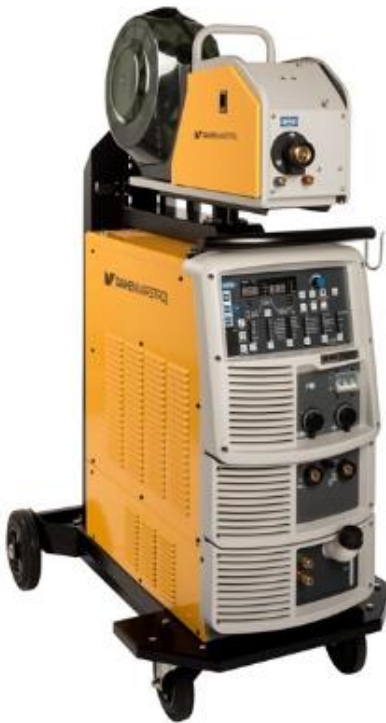
Slika 2. Uređaj za MIG/MAG zavarivanje (Welbee P400) [4]
