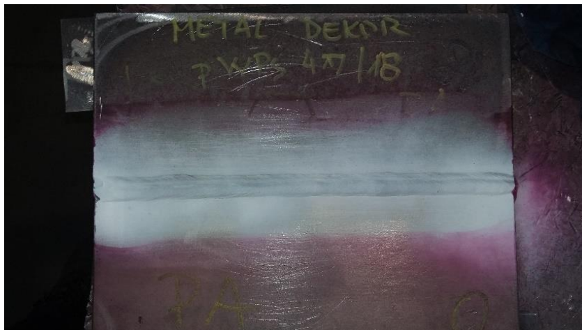
Slika 22. Nanesen razvijač na zavareni spoj koji je bez indikacija
