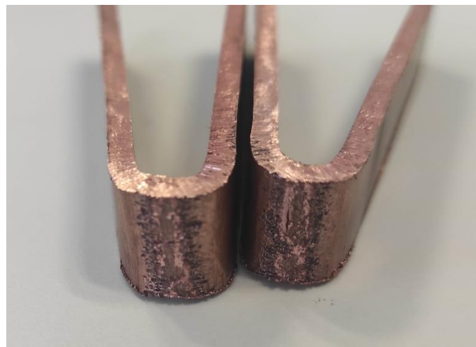
Slika 4.3.4 Savijanje lica zavara
