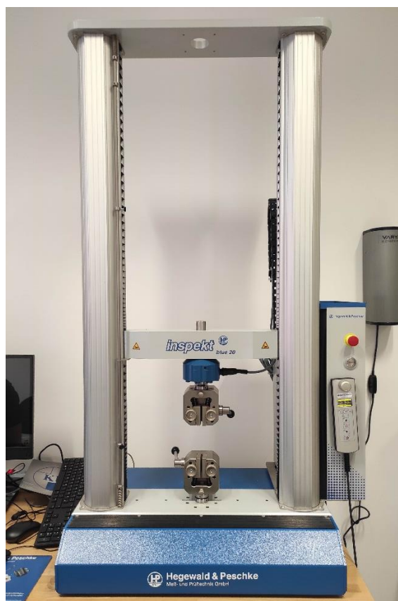
Slika 4.4.2 Kidalica za statičko vlačno ispitivanje
