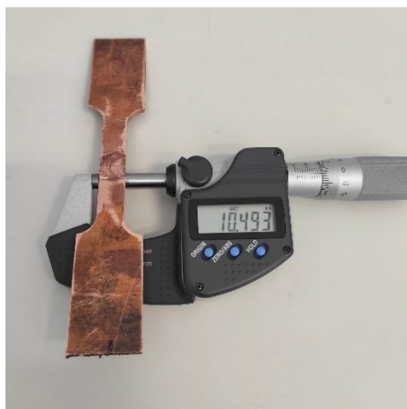
Slika 4.4.3 Širina paralelne dužine prve epruvete
