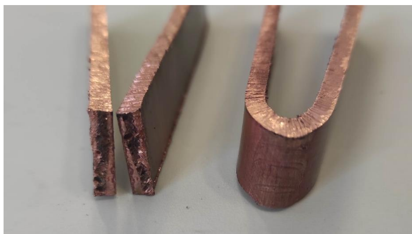
Slika 4.3.6 Savijanje lica zavora
