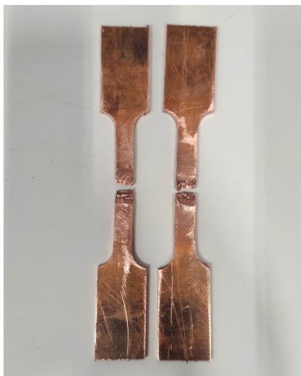
Slika 4.4.6 Epruvete nakon kidanja
