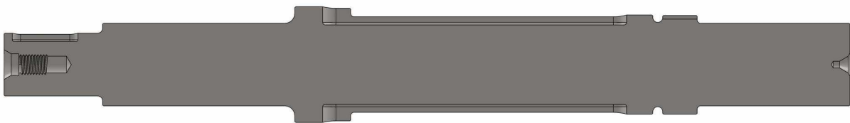
Slika 18 Preliminarna konstrukcija vratila – uzdužni presjek
