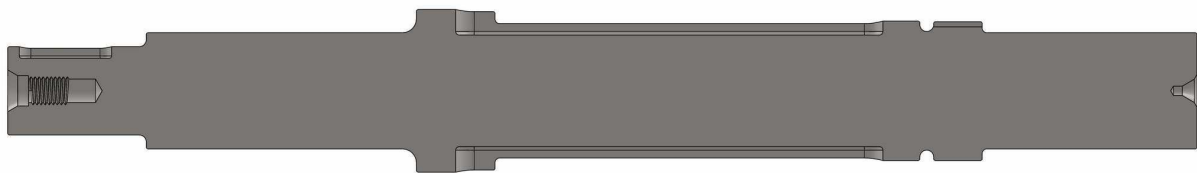
Slika 18 Preliminarna konstrukcija vratila – uzdužni presjek
