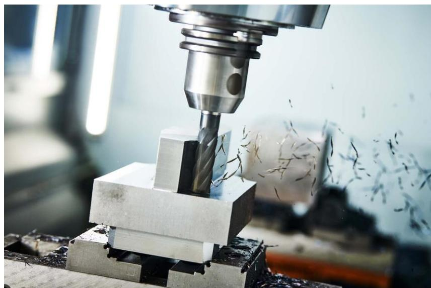
Slika 16. Gruba obrada glodanjem [8]
