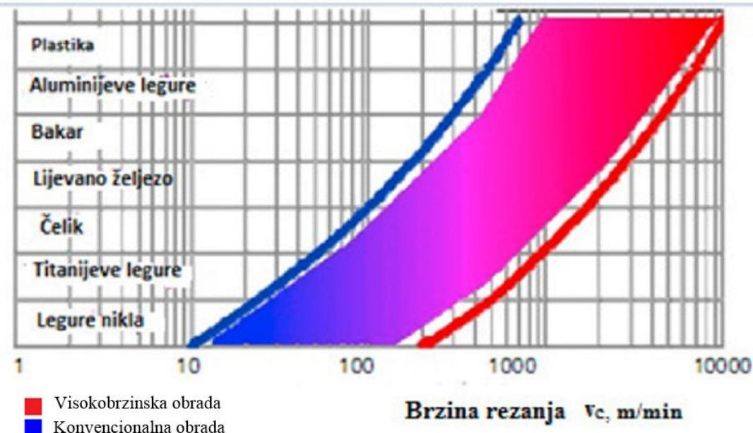
Slika 7. Brzine rezanja ovisno o materijalu obratka [6]
