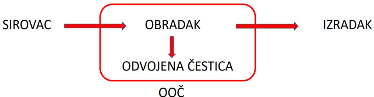
Slika 1. Postupak obrade odvajanjem čestica [1]
