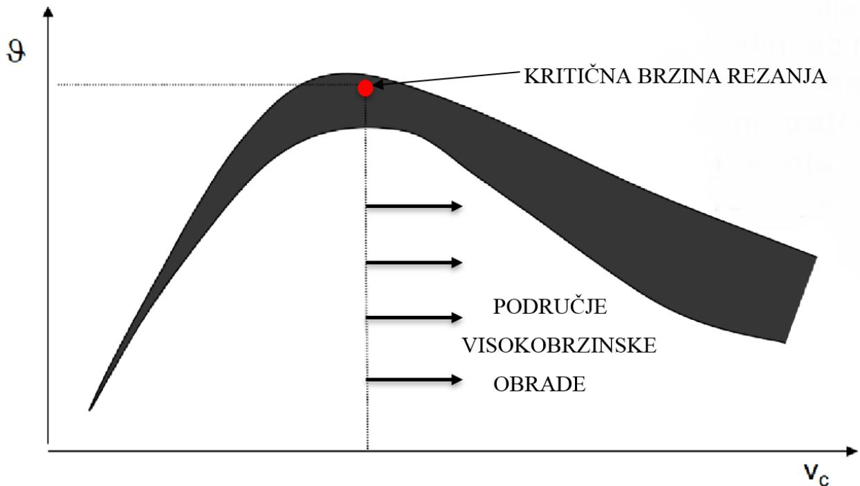
Slika 4. Ovisnost temperature o brzini rezanja [6]
