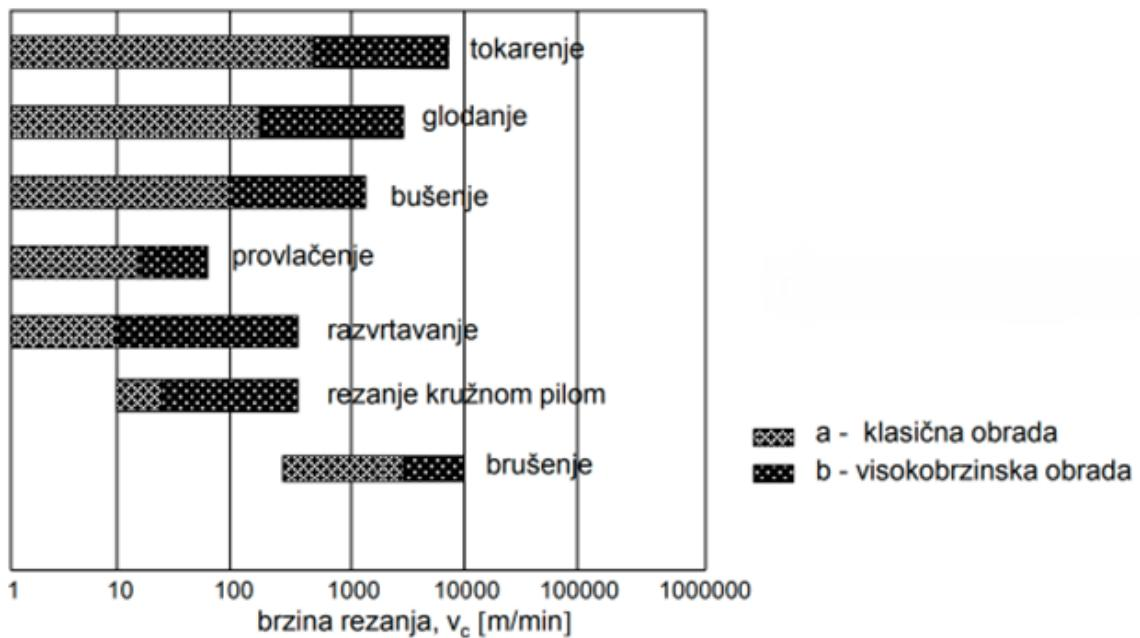
Slika 8. Podjela područja brzine rezanja čelika po Icksu [6]
