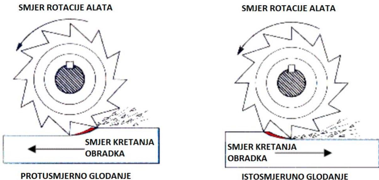
Slika 12. Istosmjerno i protusmjerno glodanje [9]
