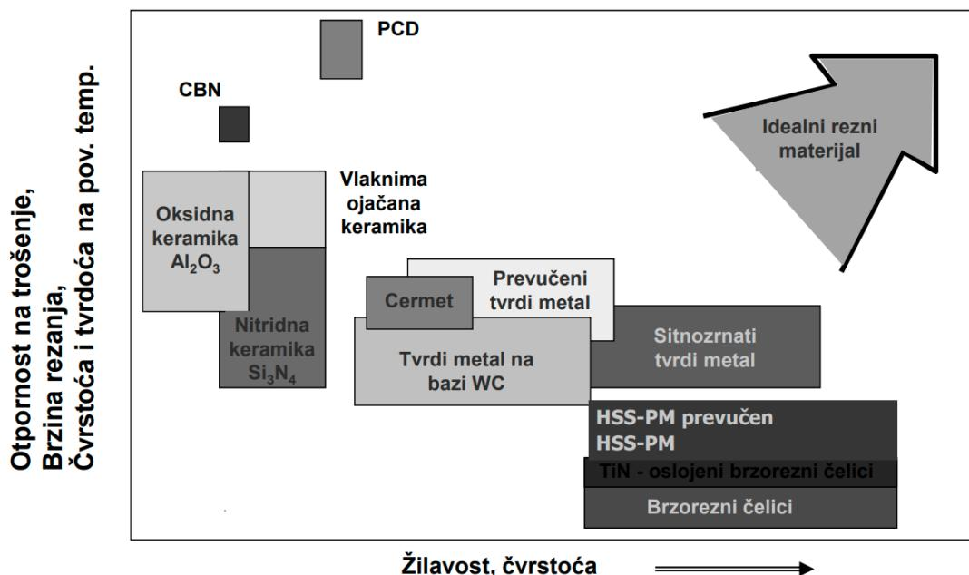
Slika 21. Materijali i prevlake reznih alata [6]
