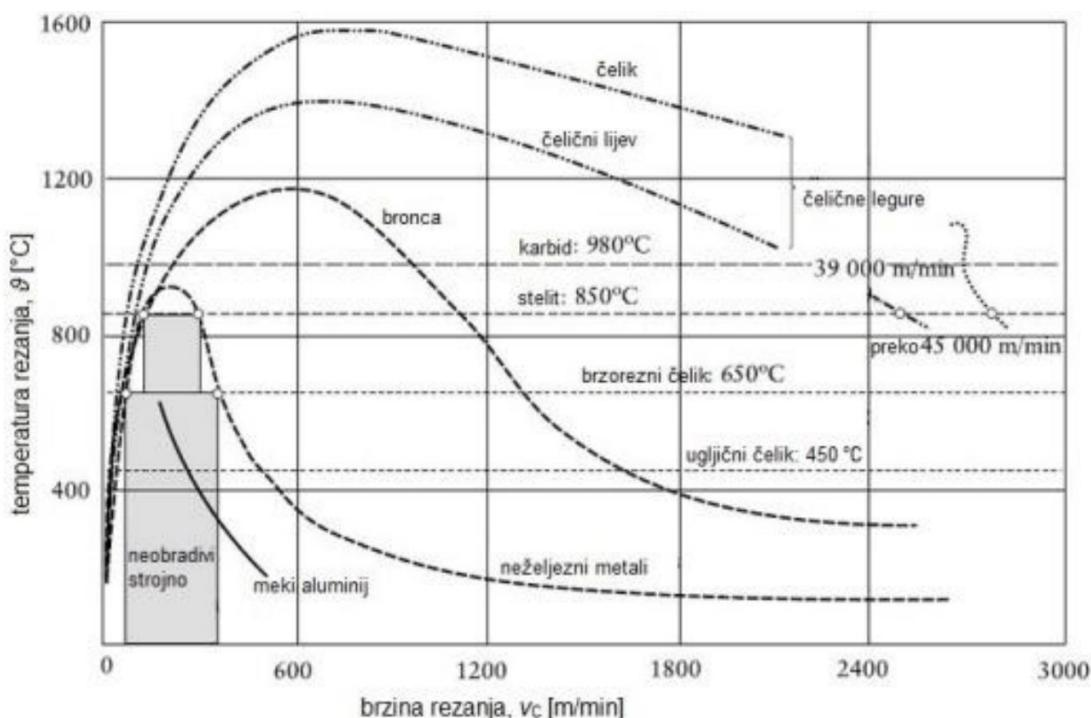
Slika 6. Ovisnost temperature i brzine rezanja kod glodanja [6]
