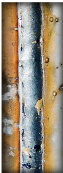
Slika 4.12 Izgled zavora kod povećanja napona [14]
