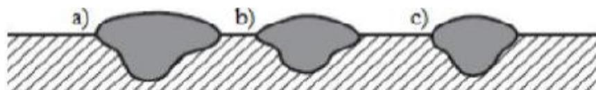
*Slika 4.14 Utjecaj brzine zavarivanja na sami oblik, širinu zavara i protaljivanje [12]*
