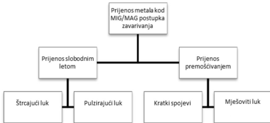
*Slika 4.4 Mehanizam prijenosa metala kod MIG/MAG zavarivanja [11]*
