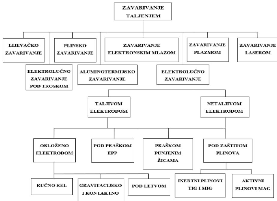
*Slika 2.3 Podjela postupka zavarivanja taljenjem. [2]*
