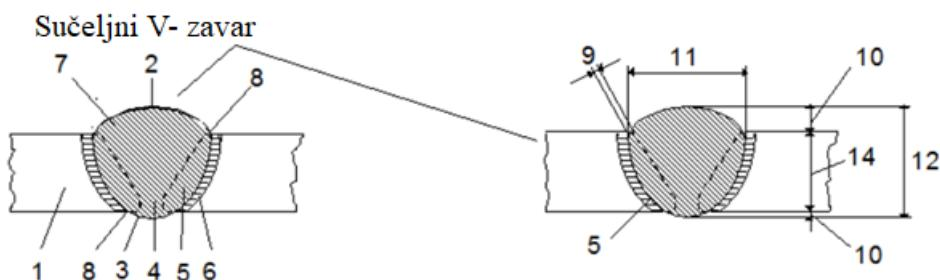
Slika 4.17 Elementi zavarenog spoja na primjeru jednoprolezognog zavara [6]
