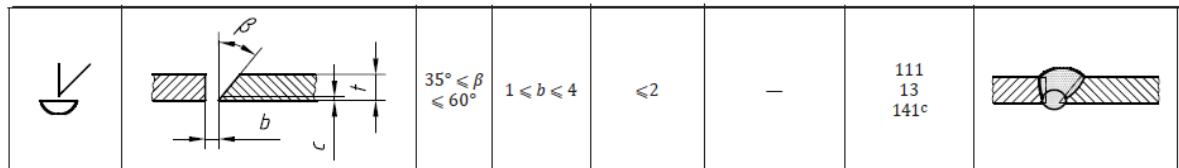
*Slika 5.12 Priprema spoja za sučeljni zavar*
