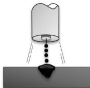
Slika 4.5 Prijenos metala štrcajućim lukom [11]
