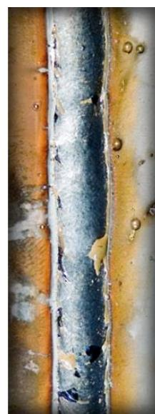
*Slika 4.12 Izgled zavara kod povećanja napona [14]*
