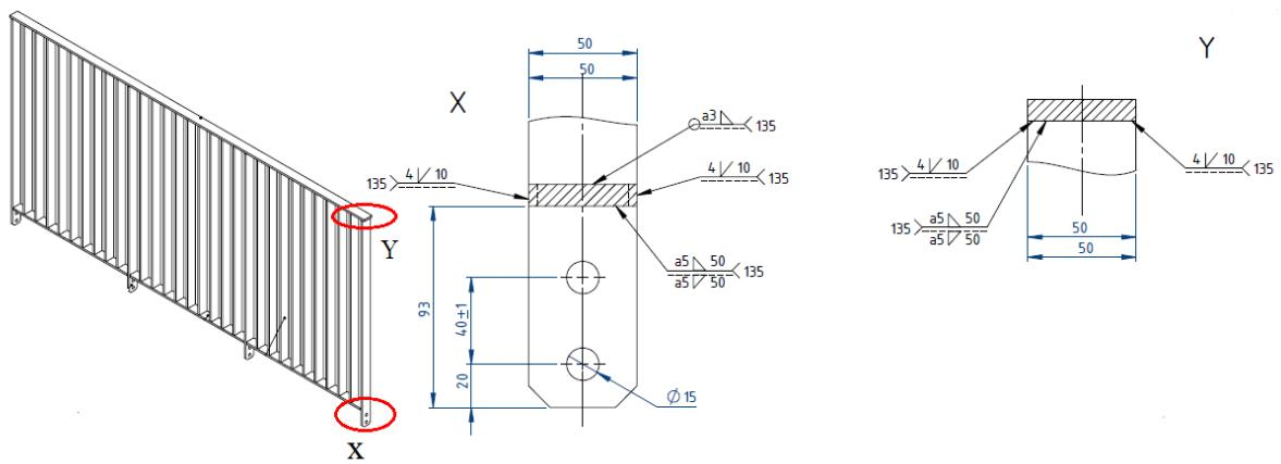
Slika 5.21 Prikaz i oznake zavarivanja na nacrtu
