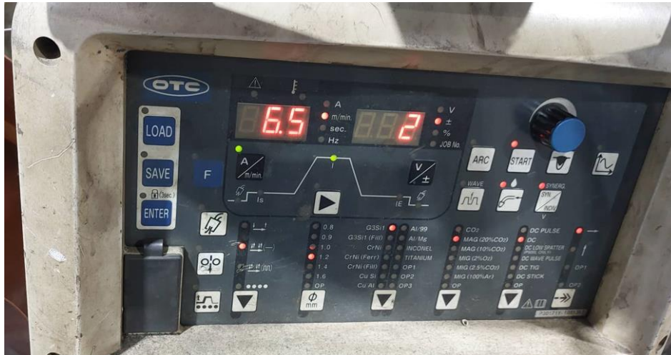
Slika 5.29 Parametri kod zavarivanja stupa konstrukcije
