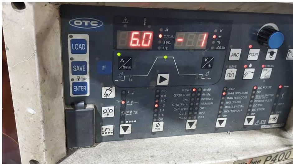
*Slika 5.25 Parametri kod zavarivanja bočnice konstrukcije*
