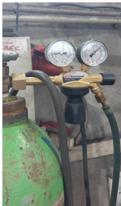
Slika 5.30 Prikaz brzine izlaska plina na manometru
