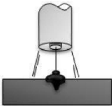
*Slika 4.7 Prijenos metala kratkim spojevima [11]*
