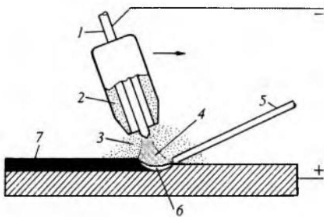
*Slika 3.4 Zavarivanje volframnom elektrodom u inertnoj atmosferi*
