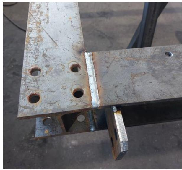
*Slika 5.17 Detalj zavarene konstrukcije MIG/MAG postupkom*
