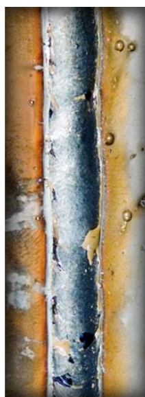
Slika 4.12 Izgled zavora kod povećanja napona [14]
