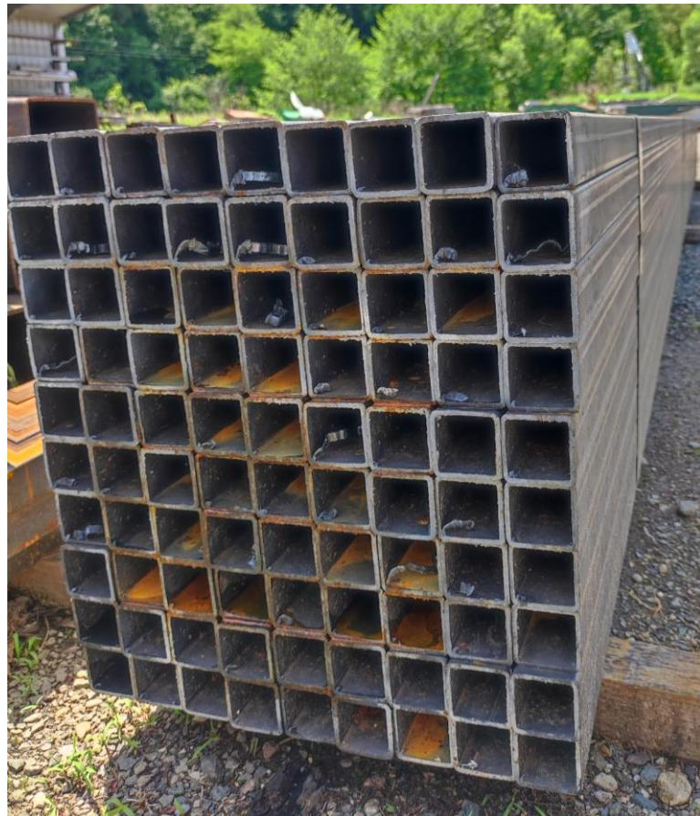
Slika 13: Primjer cijevnih profila
