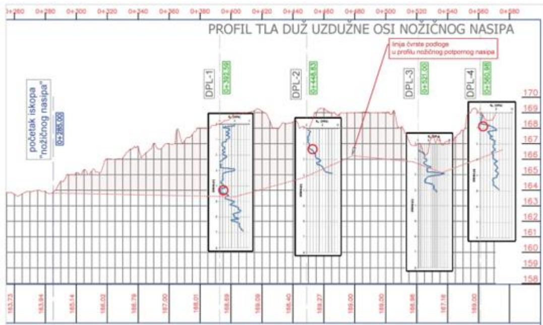
Slika 22: Rezultati dinamičkog sondiranja tla duž uzdužne osi nožićnog nasipa[1]
