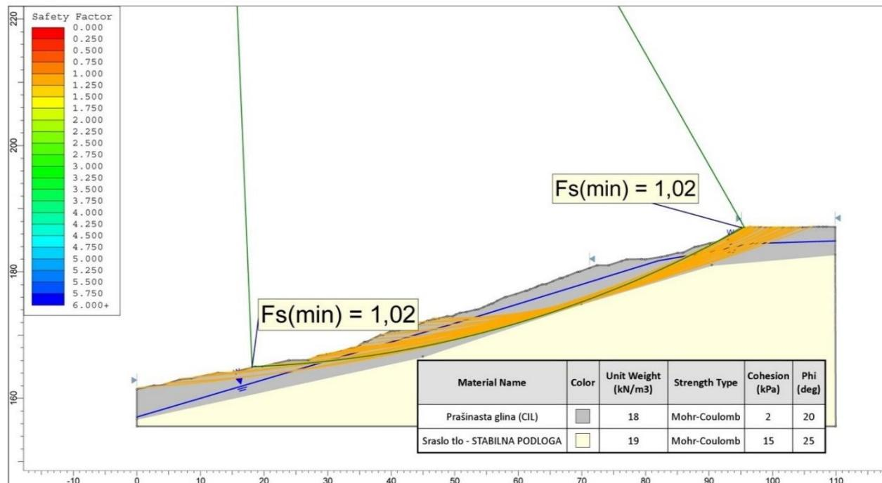
Slika 30: Analiza stabilnosti kosine glinokopa "Durđevičev brijež" - profil PP4(zatečeno stanje)[1]
