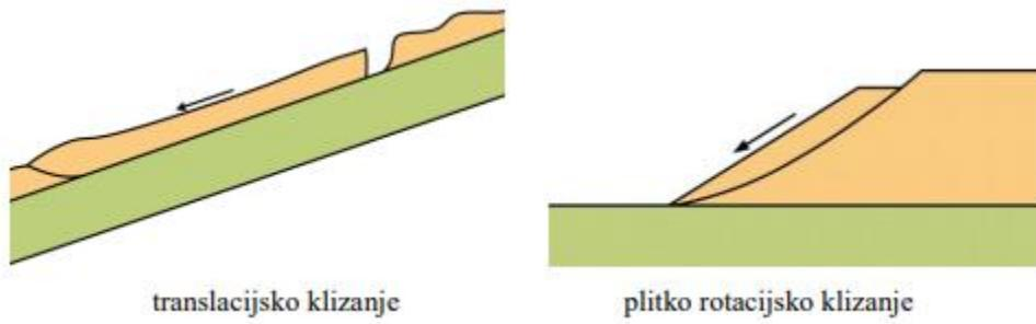
Slika 5: Translacijsko klizanje i plitko rotacijsko klizanje[3]
