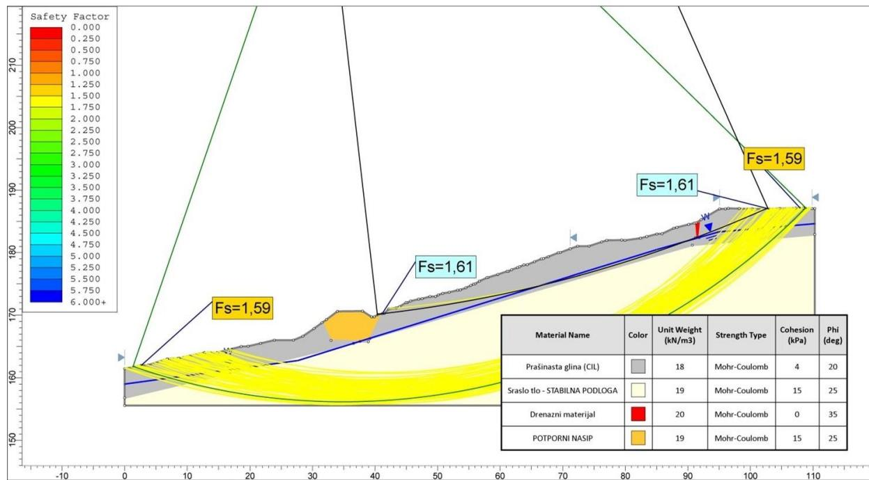
Slika 32:Analiza stabilnosti kosine glinokopa "Đurđevičev brijeg" - profil PP4(izgradnja bedema)[1]
