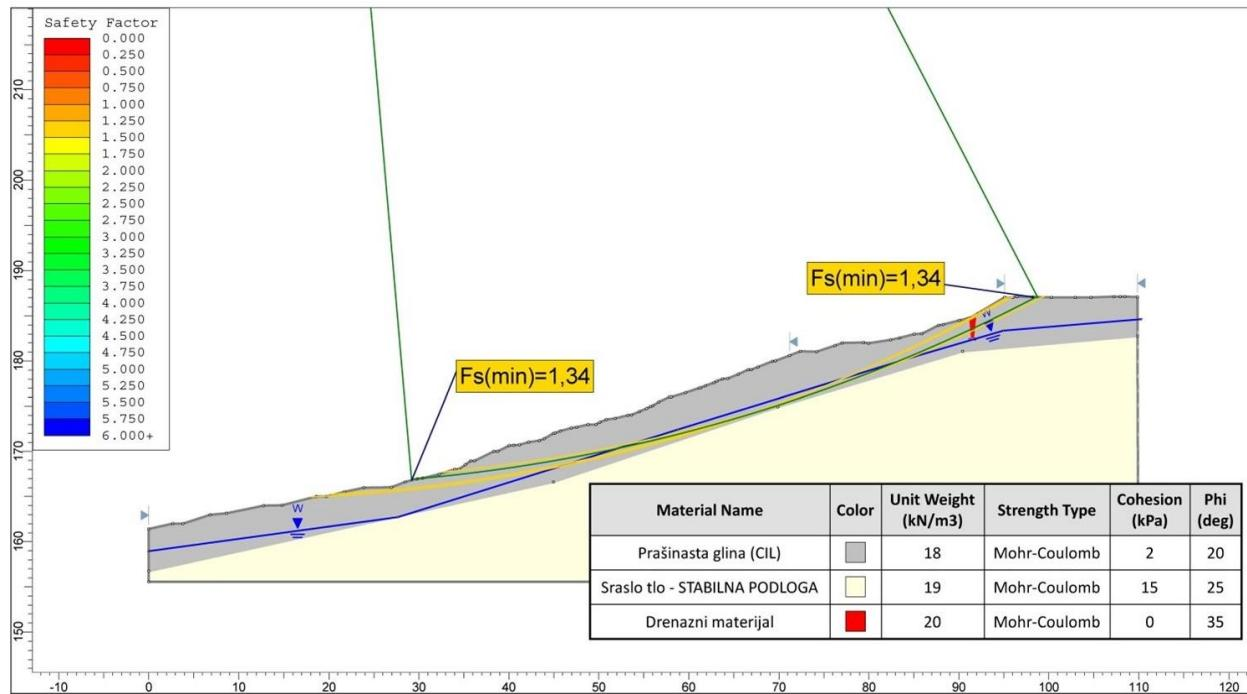
Slika 31: Analiza stabilnosti kosine glinokopa "Đurđevičev brijeg"-profil PP4(ugradnja drena)[1]
