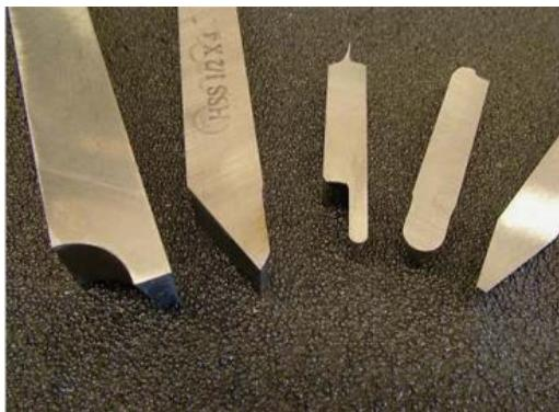
Slika 3.4 Tokarski nož od brzoreznog čelika [8]
