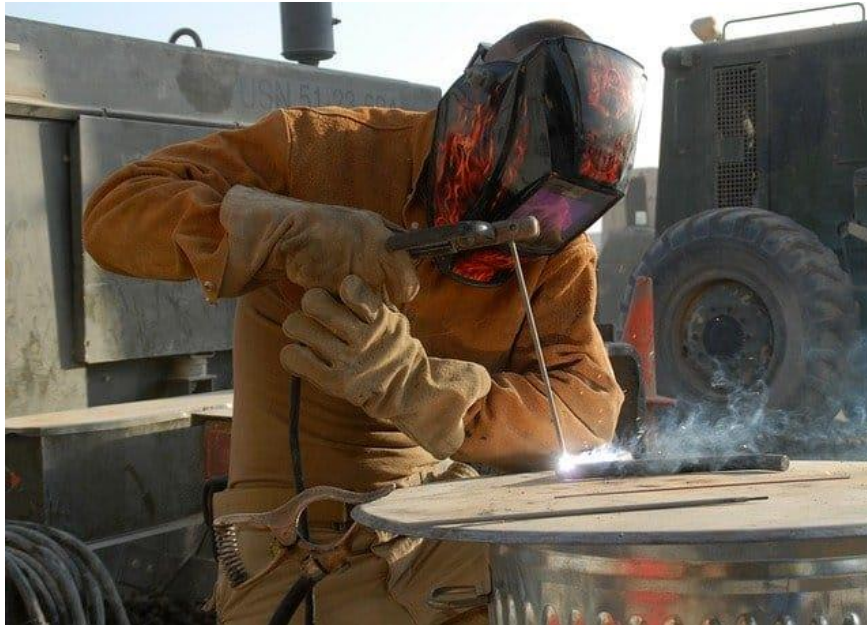
Slika 2. Zavarivanje REL postupkom [5]
