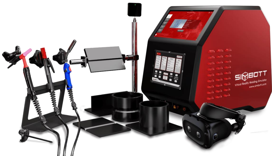
Slika 30. Oprema SIMBOTT simulatora za zavarivanje [29]
