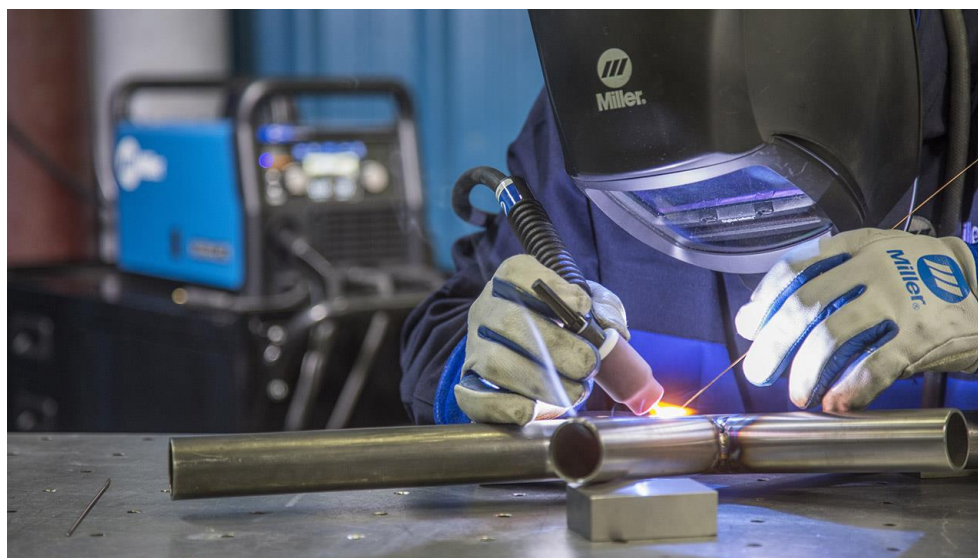
Slika 3. Zavarivanje TIG postupkom s dodavanjem dodatnog materijala [7]
