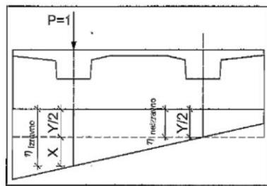
Ako je vrijednost X koja se prenosi savijanjem izravnog opterećenja nosača, a Y je dio utjecaja koji se preraspodjeljuje na oba nosaca zbog torzijske krutosti presjeka vrijedi:
