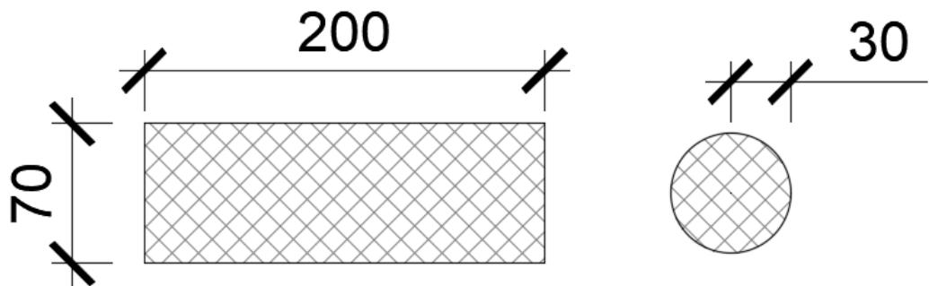
Slika 4.3. Presjek luka i stupa sa prikazanim dimenzijama (Izvor: Autor)
