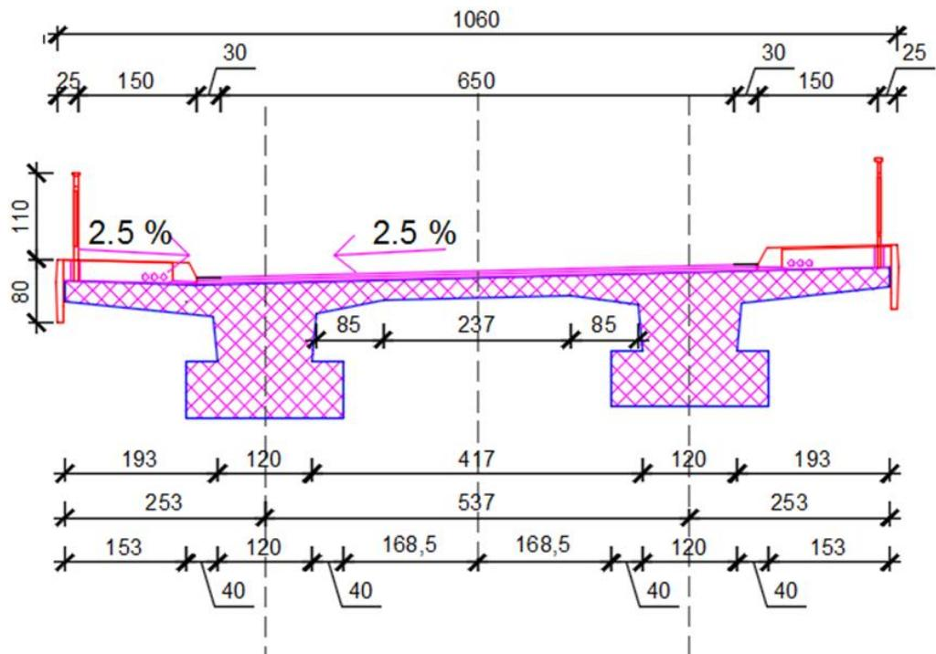
*Slika 4.1. Poprečni presjek nosača (Izvor: Autor)*
