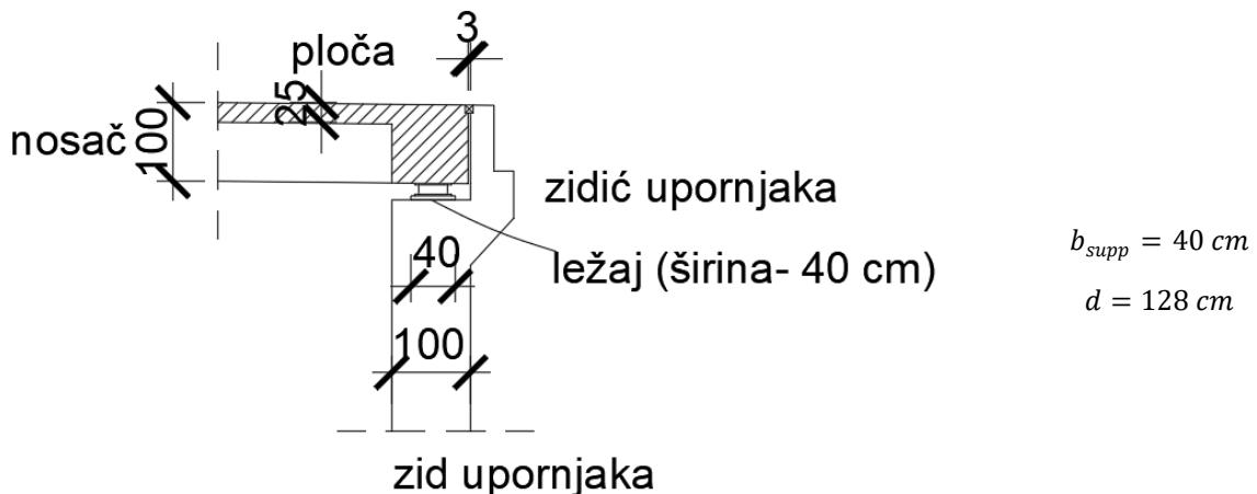
$$\Delta V_{Sd} = (1,35 \cdot 123,57 + 1,5 \cdot 23,089) \cdot \left( \frac{0,4}{2} + 1,28 \right) = 298,15 \text{ kN}$$
