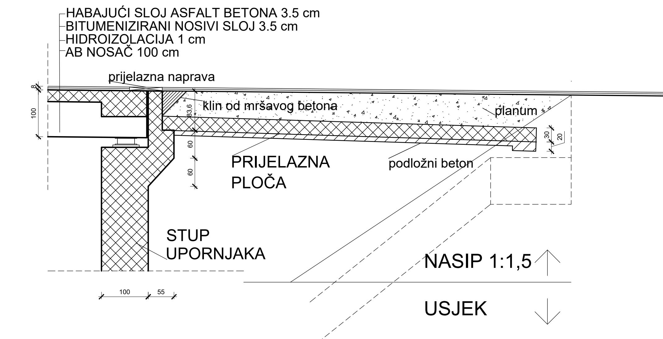
**POPREČNI PRESJEK A-A**
