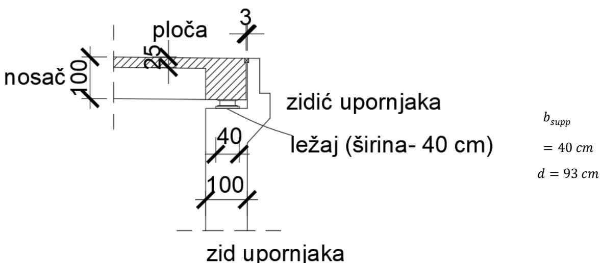
$$\Delta V_{Sd} = (1,35 \cdot 123,57 + 1,5 \cdot 23,089) \cdot \left( \frac{0,4}{2} + 0,93 \right) = 227,64 \text{ kN}$$
