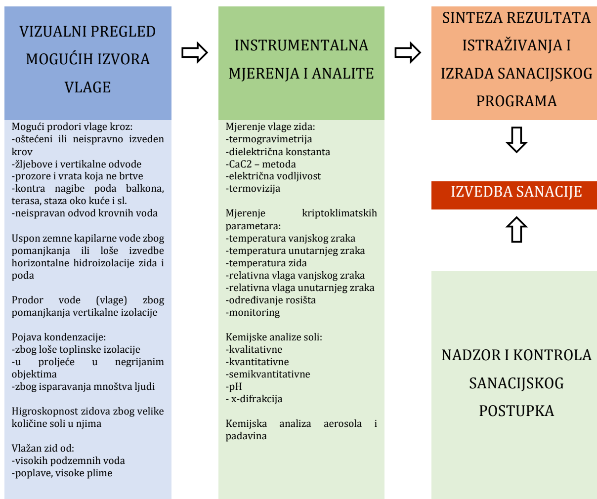
Grafikon 4.1 – Shematski prikaz postupaka dijagnosticiranja vlage [Izvor: Malinar, H. (2003): Vлага u povijesnim građevinama, Zagreb]
