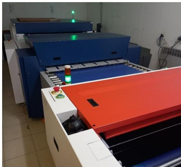
Nakon izlaska ploče iz kemikalija ona ulazi u korito s vodom u kojem se nalaze valjci koji ispiru i odstranjuju ostatke razvijača. Kako bi se povećalo prianjanje boje na tiskovne površine strojno i kako bi se ploča zaštitila nanosi se sredstvo za gumiranje ploča koje se
