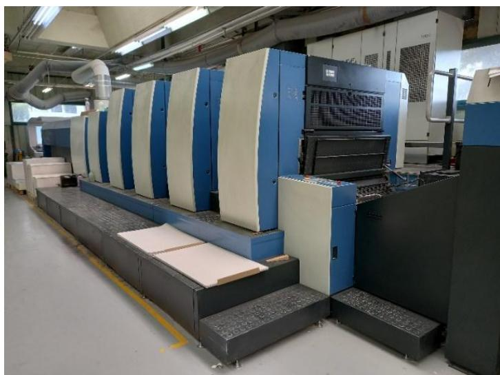
Nakon ulaganja papira, pripreme ploča i pokretanja programa koji stroju daje upute, kreće se sa otiskivanjem otisaka. U početku je uvijek intenzitet boja visok, ali nakon nekoliko otisaka on se stabilizira što pokazuje kamera u stroju koja prema klinu automatski mjeri intenzitet boje pa s toga nije potrebno ručno denzitometrom mjeriti jakost boje. Jedino što kamera ne može snimiti su greške, pa se s toga svakih nekoliko otisaka mora izvaditi da bi se provjerila kvaliteta.
