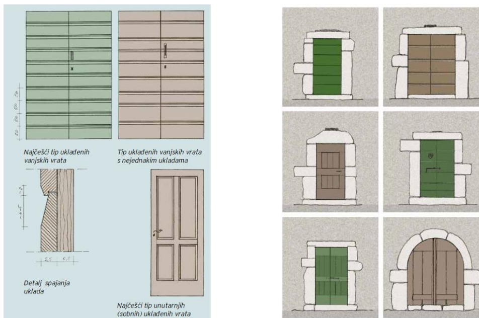
Skica 16: Izvedba stolarije na staroj kamenoj kući [4]
