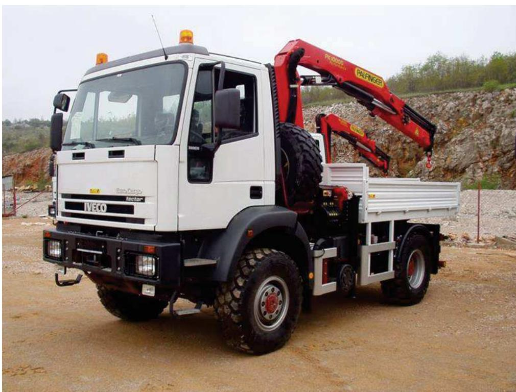
*Slika 6. teretno vozilo s radnom nadogradnjom i tovarnim prostorom nosivosti do 12000 kg*
