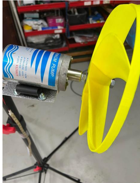
Slika 4.6. Montiranje prve verzije lopatica na osovinu generatora
