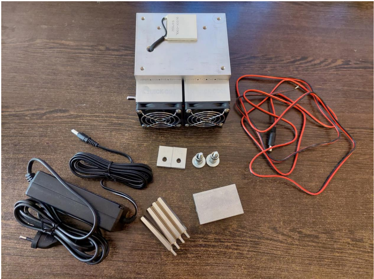
Slika 4.7 Sadržaj Peltier istraživačkog seta
