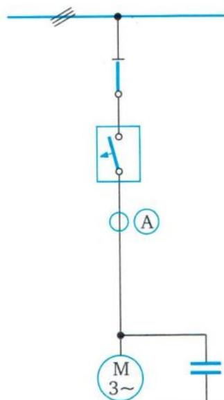
Slika 12. Pojedinačna kompenzacija, jednopolna shema [5]
