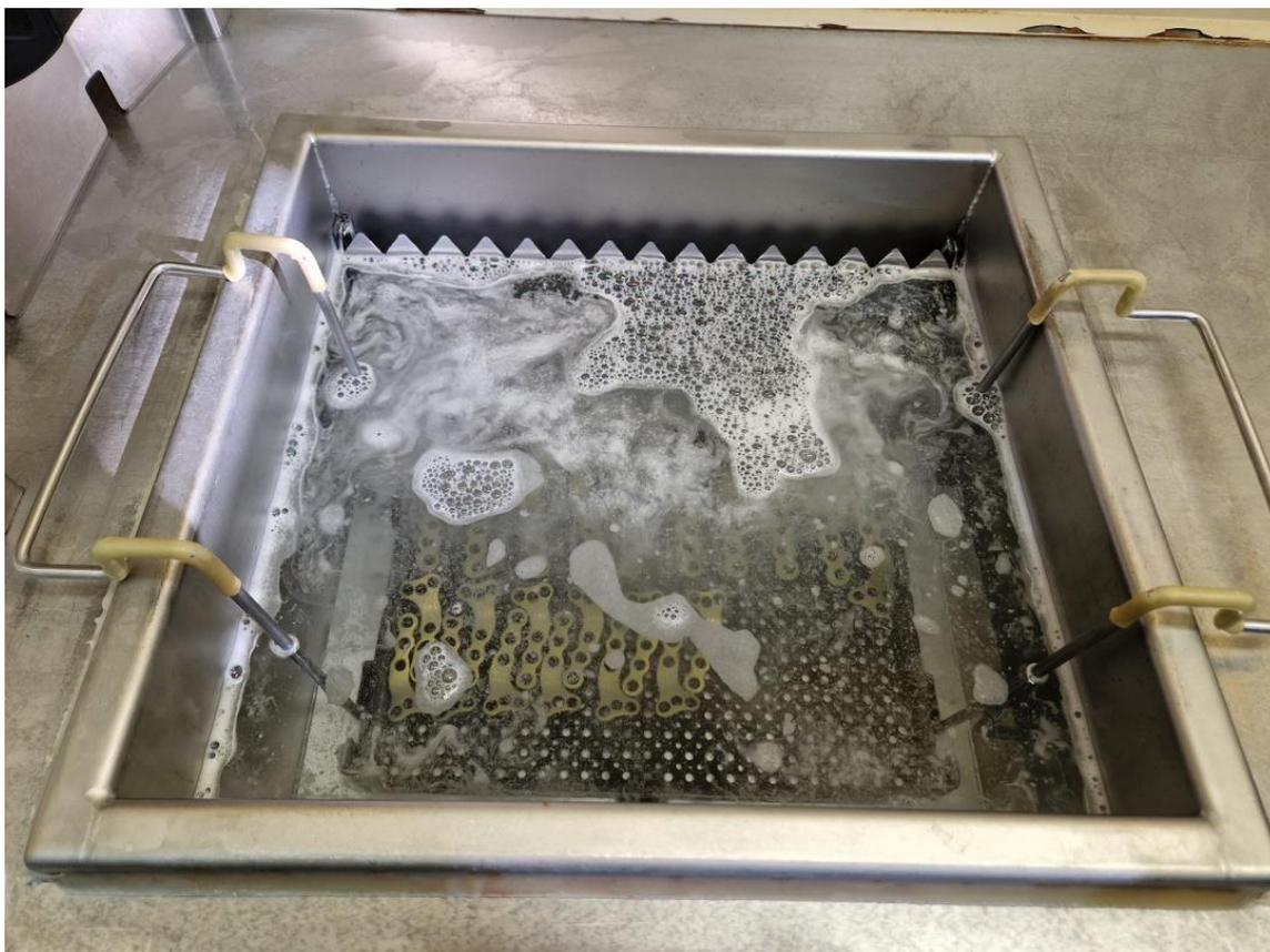
*Slika 32. Kratkotrajno pasiviranje*
