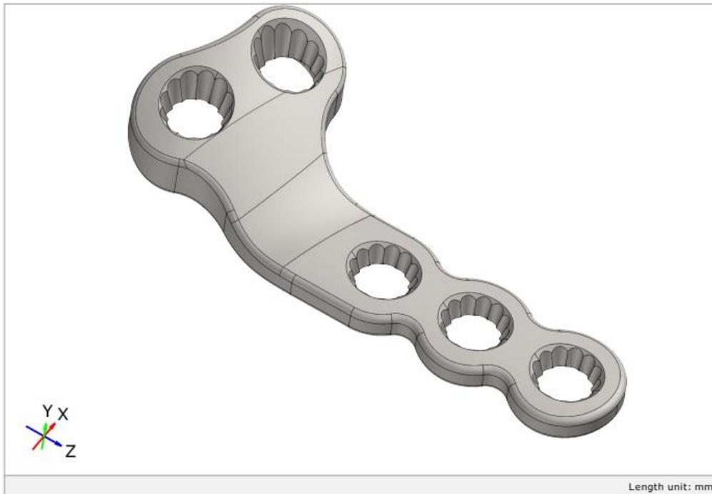
*Slika 46. Model skenirane pločice*
