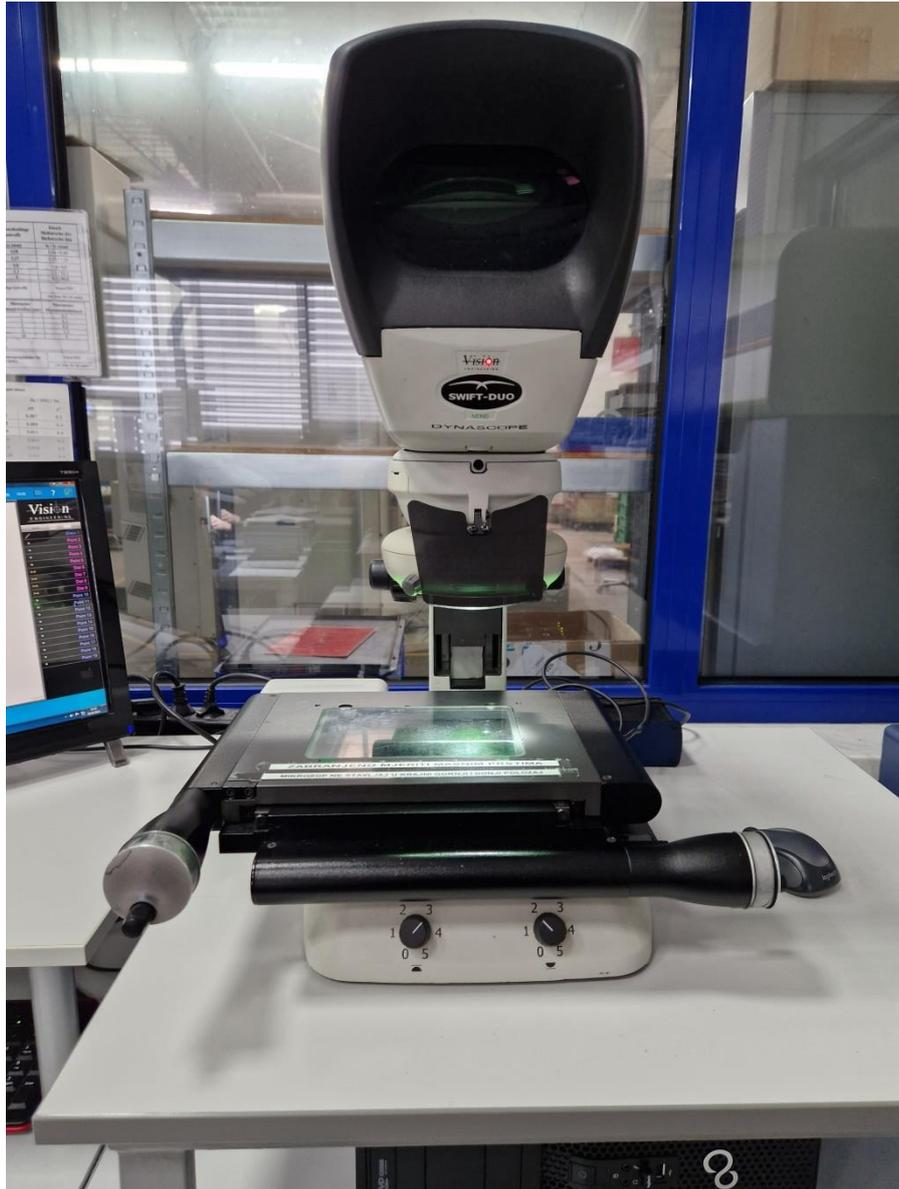
*Slika 21. Optički mikroskop*
