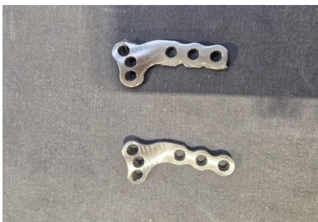
Slika 17. Pločica nakon prvog i drugog stezanja
