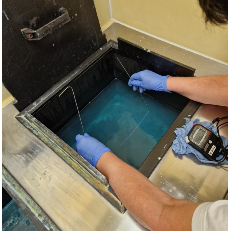
Slika 22. Postavljanje vremena za bajcanje
