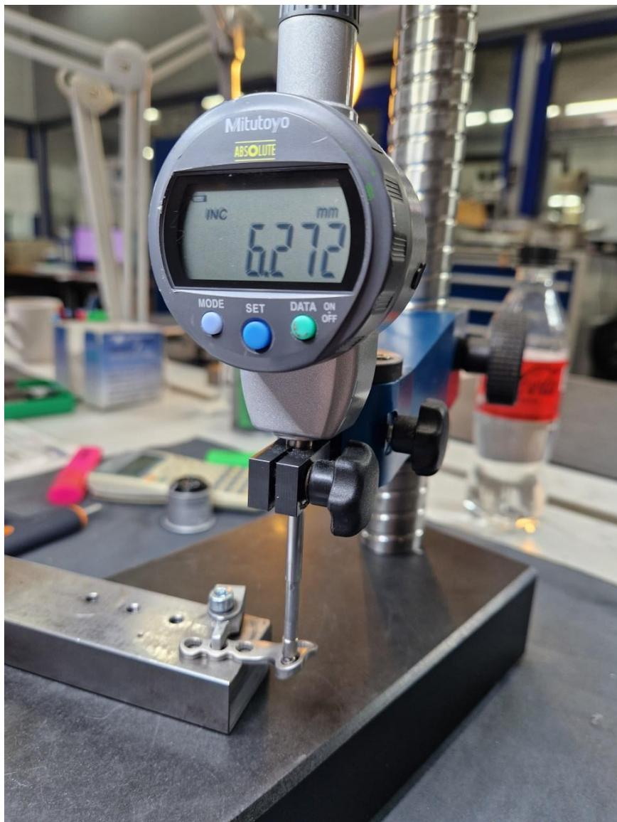
*Slika 37. Mjerenje visine kuglice*
