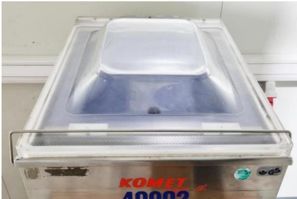
*Slika 34. Uređaj za vakuumiranje*
