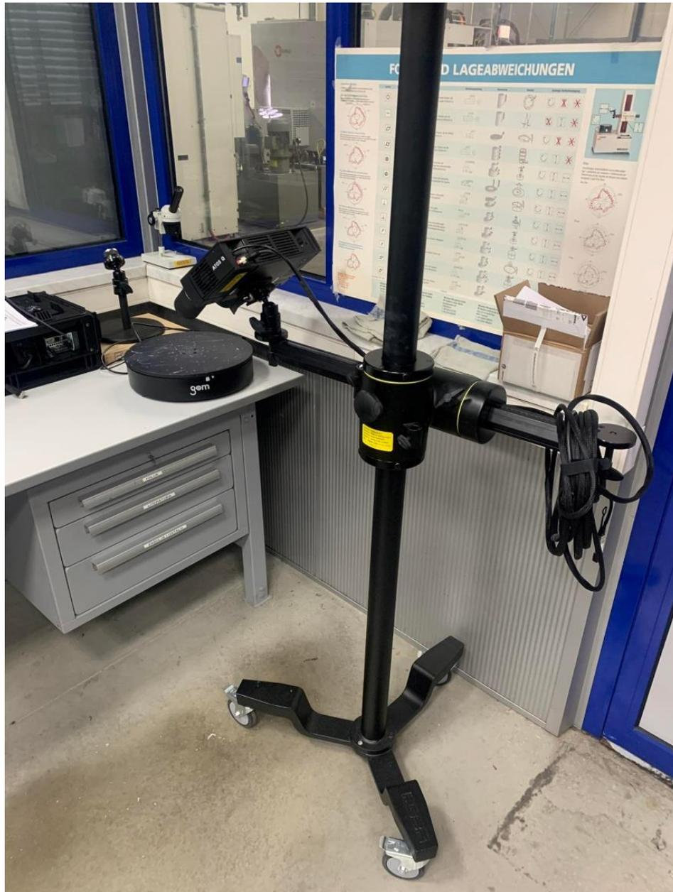
*Slika 43. Skener Atos Q8 s postoljem*
