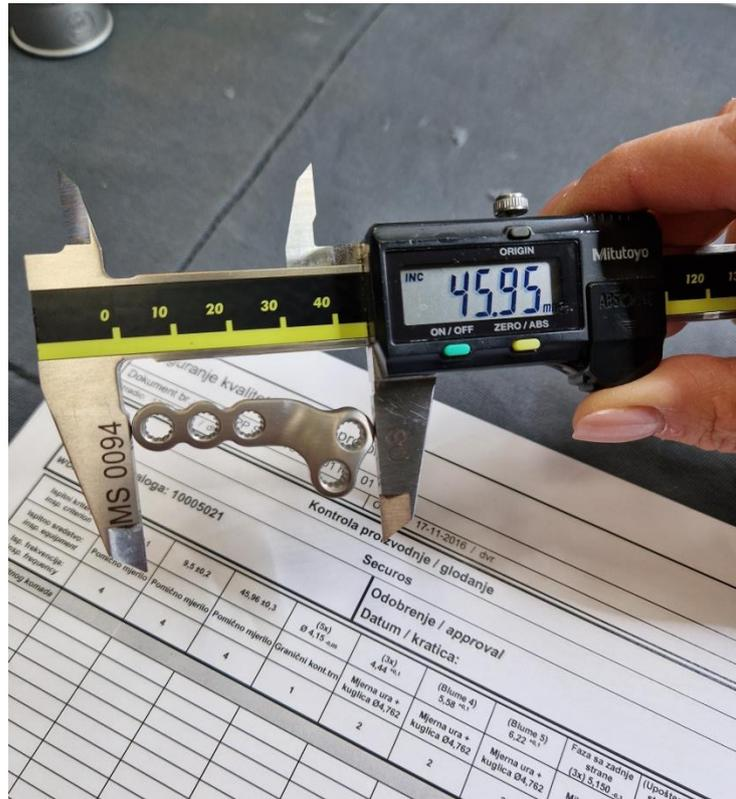
Slika 38. Mjerenje pomičnim mjerilom
