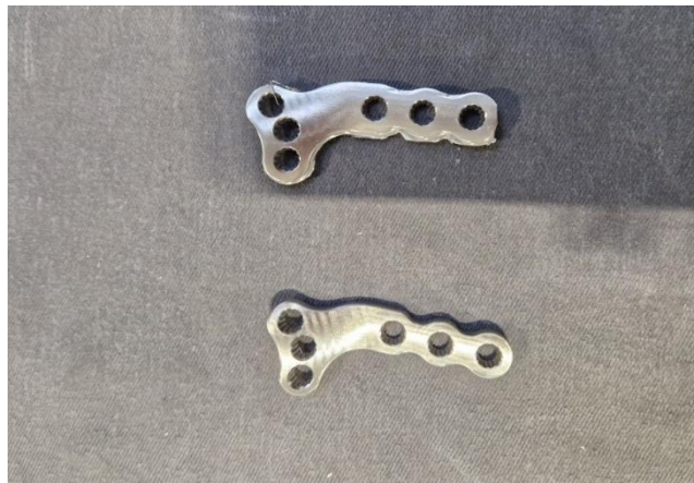
Slika 17. Pločica nakon prvog i drugog stezanja
