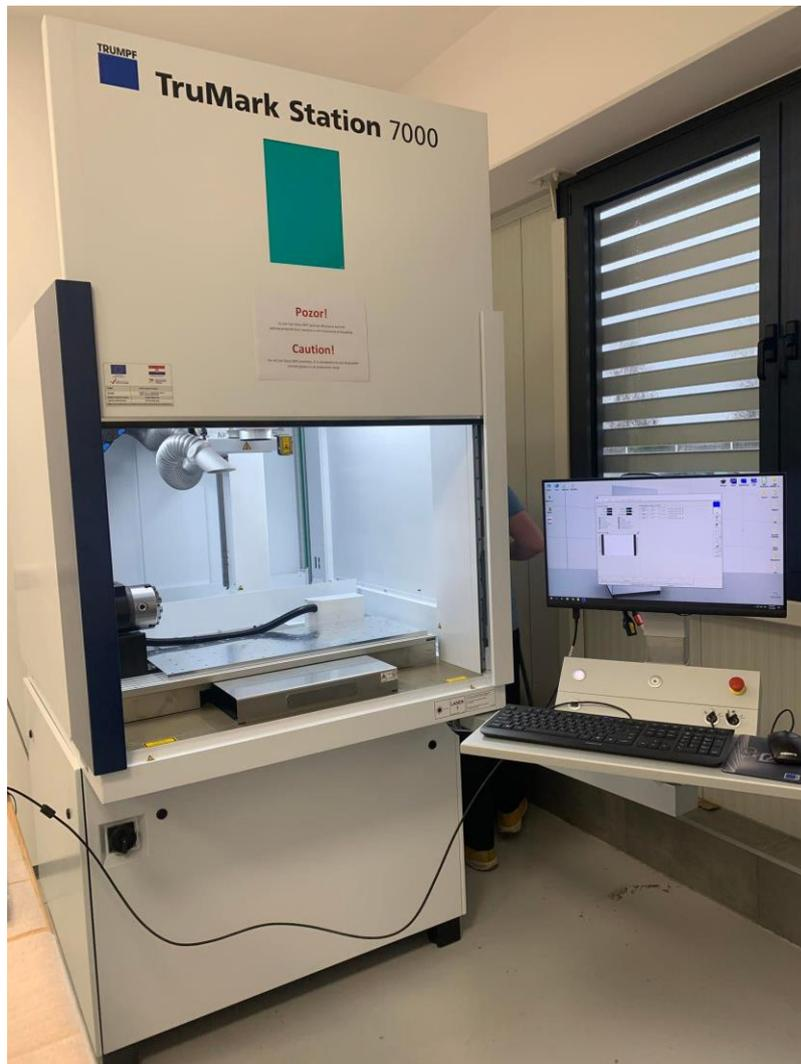
*Slika 28. Stroj za lasersko označavanje*
