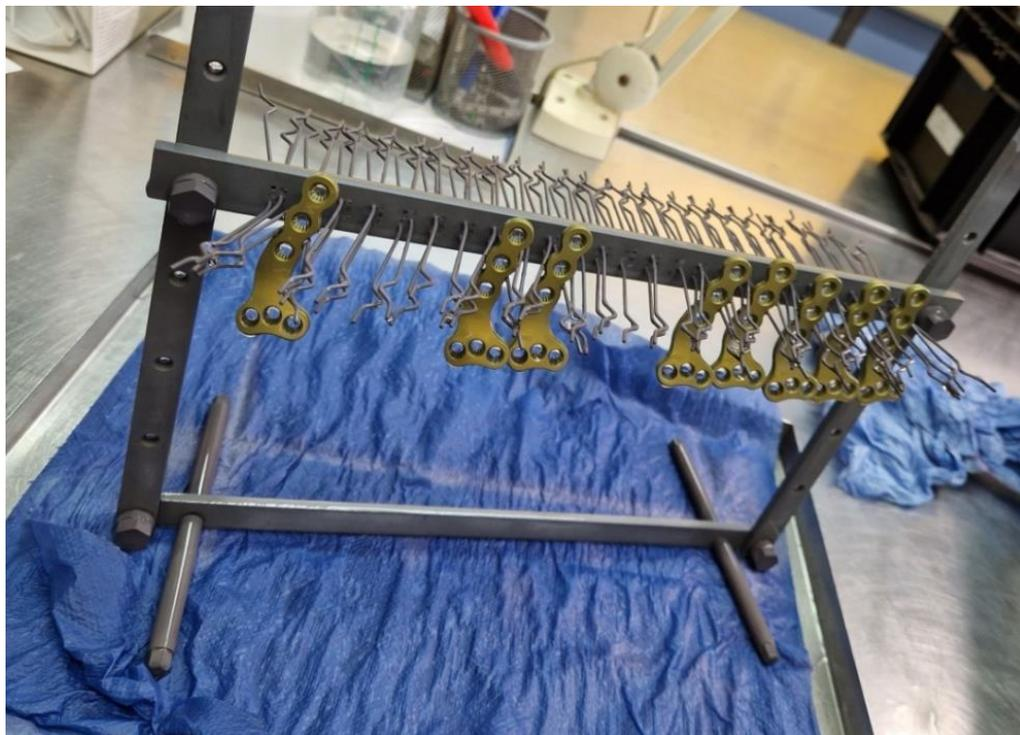
*Slika 27. Anodizirane pločice*
