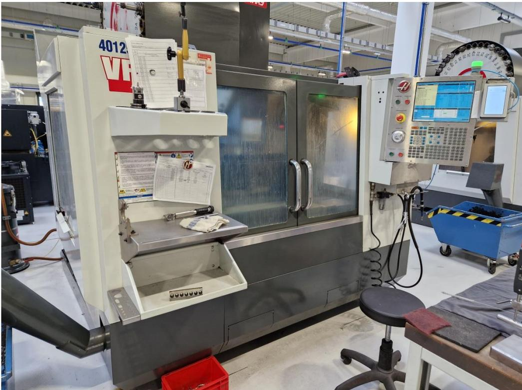
*Slika 12. Obradni centar HAAS VF-2SSYT*
