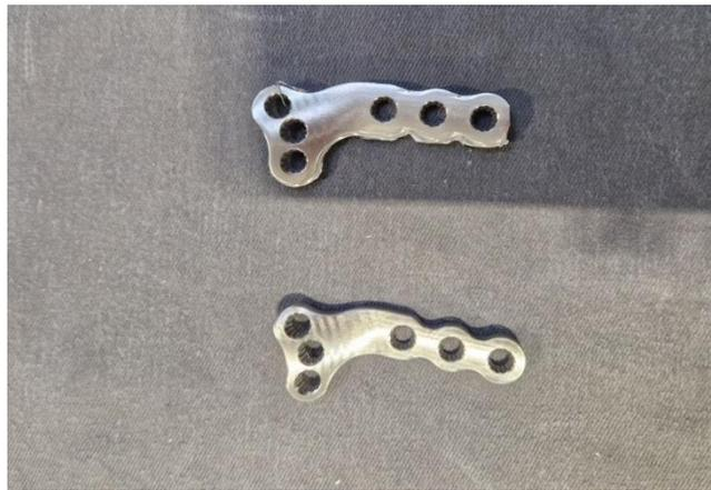
*Slika 17. Pločica nakon prvog i drugog stezanja*
