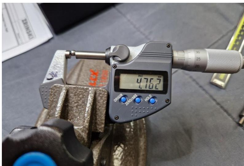
Slika 41. Mjerna kuglica
