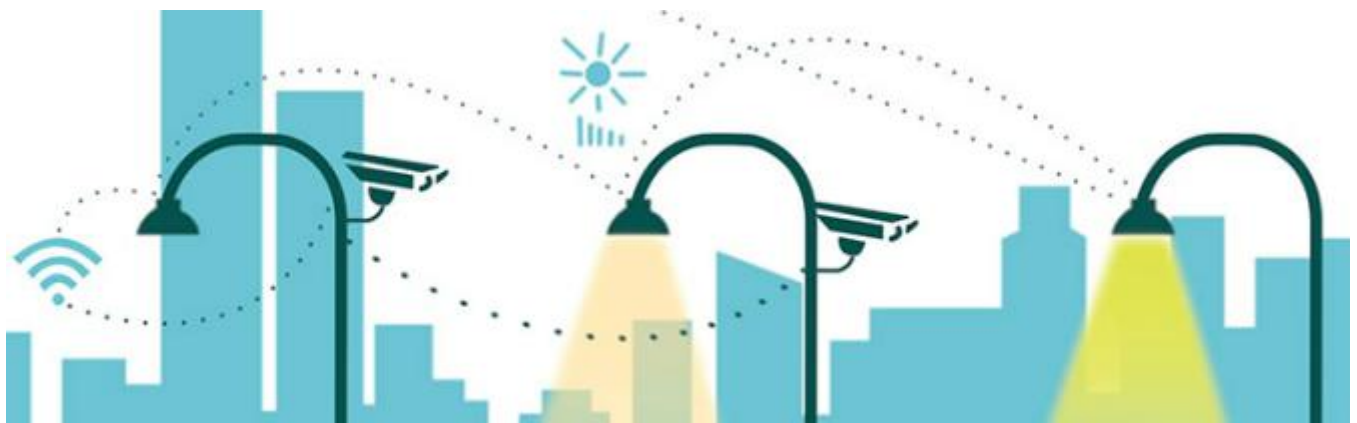
Slika 57. Primjer prilagodljive rasvjete – detekcija pješaka/biciklista Izvor: https://www2.illinois.gov/sites/doit/Strategy/Pages/sslworkshop.aspx
