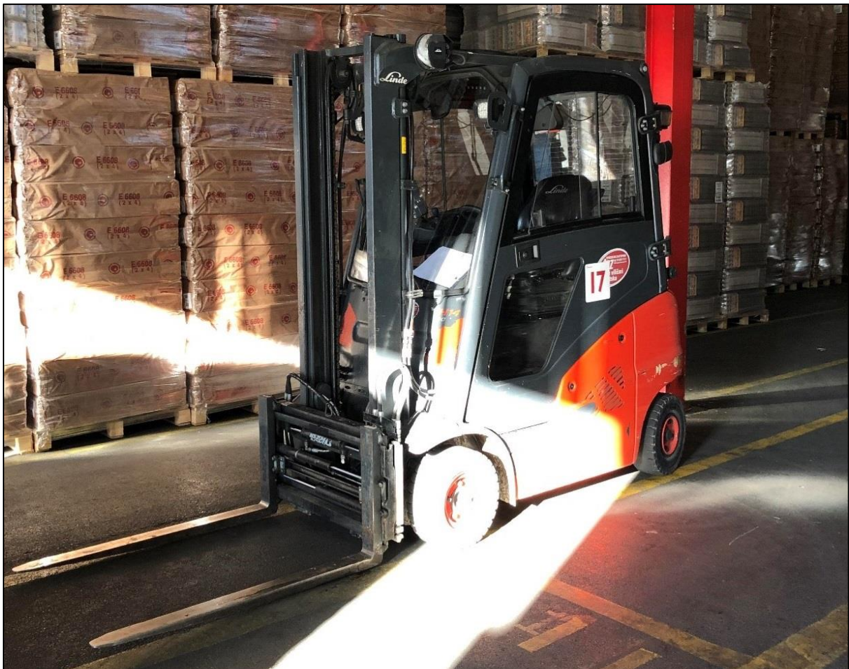
Slika 4.7. Čeoni viličar na plinski pogon
