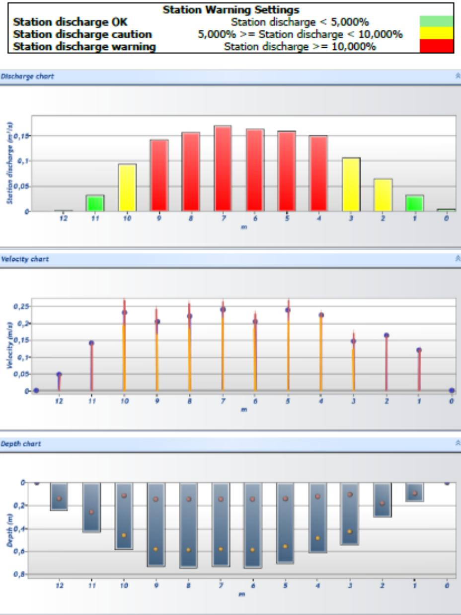
Slika 6.6. Grafički prikazi rezultata mjerenja u Ludbregu – prikaz protoka, brzina i dubina na svakoj mjernoj stanici
