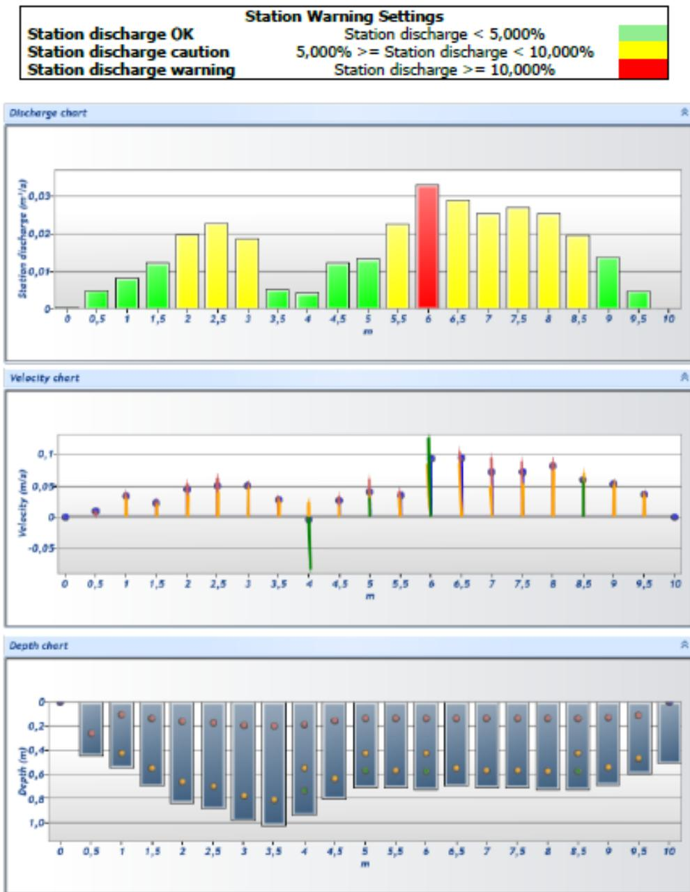
Slika 6.2. Grafički prikazi rezultata mjerjenja u naselju Narta – prikaz protoka, brzina i dubina na svakoj mjernoj stanici
