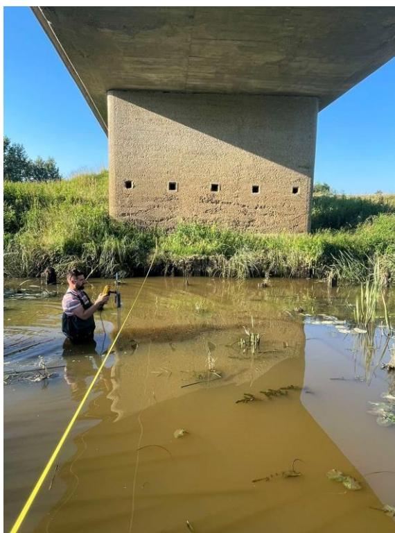
Slika 5.14. Hidrometrija na 0+005,00 m od lijeve obale rijeke Česme
