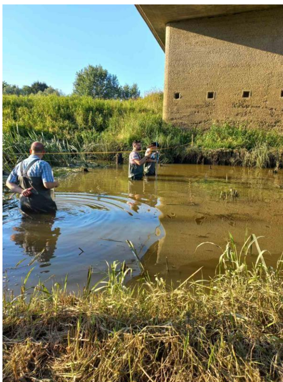
Slika 5.15. Hidrometrija na 0+007,50 m od lijeve obale rijeke Česme
