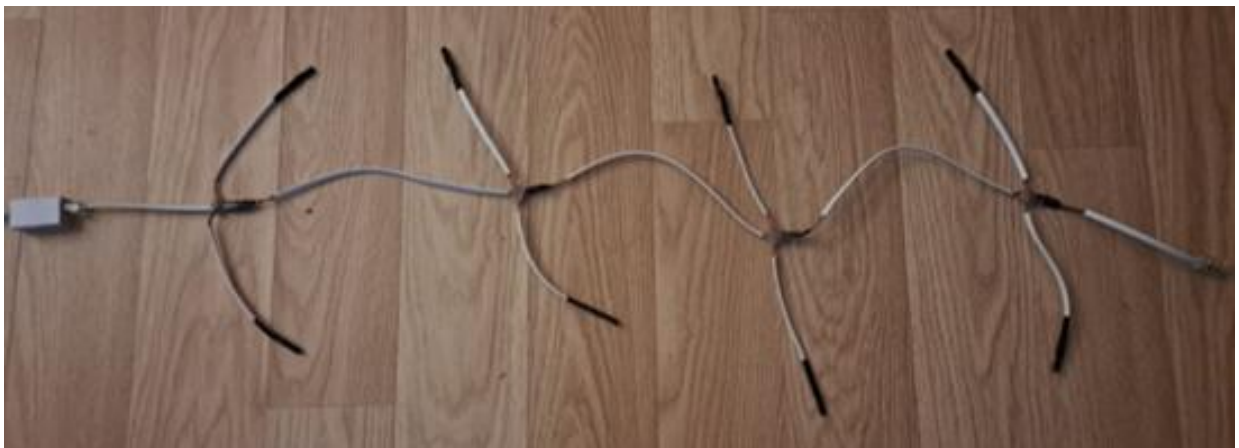
Slika 3.24. Realni model spojenih senzora topline dužine 1 metar
