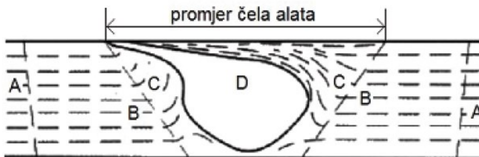
Slika 19. Skica poprečnog presjeka zavora dobivenog FSW postupkom zavarivanja:
