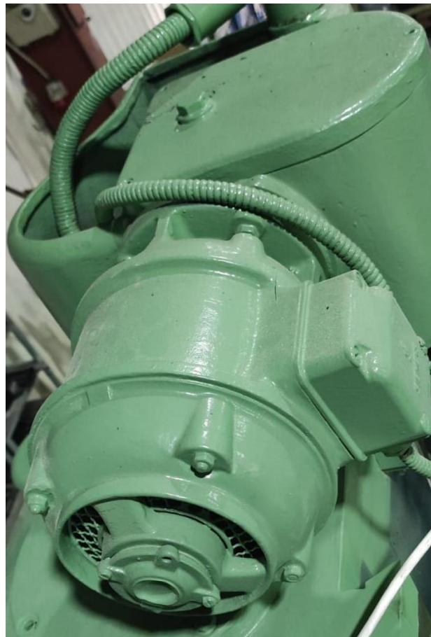
Slika 2.13. Elektromotor za pokretanje konzole
