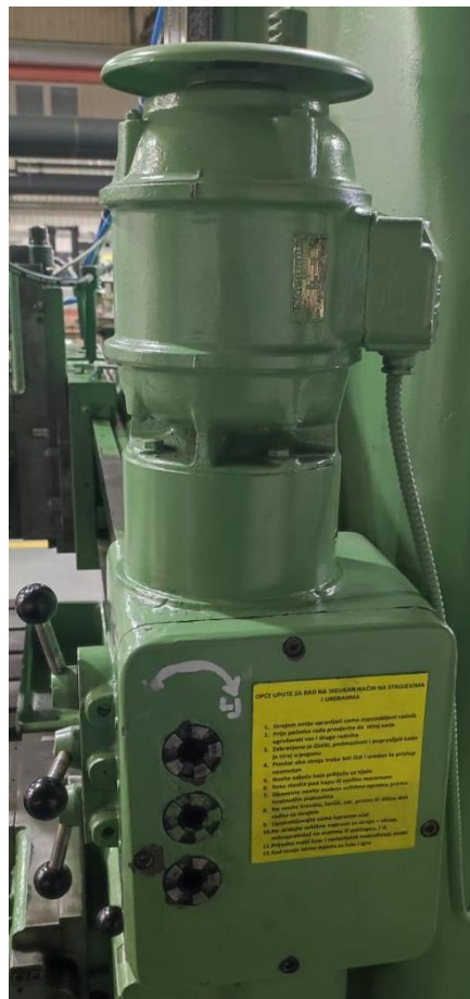
Slika 2.11. Elektromotor za brzi posmak suporta
