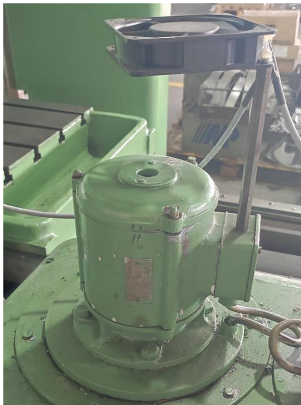
Slika 2.15. Elektromotor za kretanje stola
