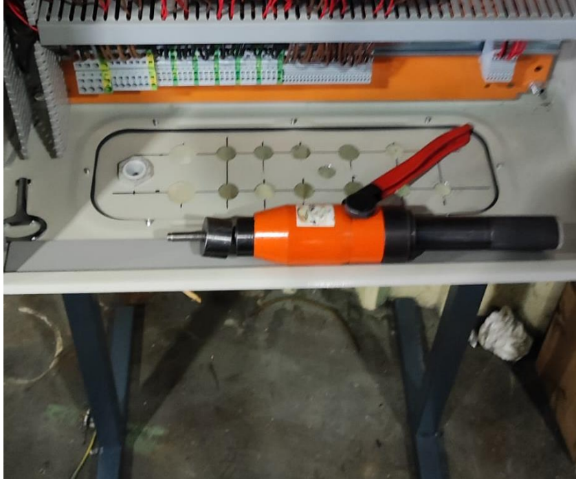
Slika 4.4. Bušenje rupa za uvodnice prema nacrtanom rasporedu
