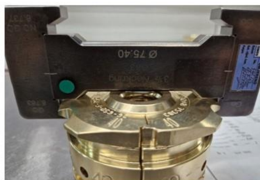
Slika 41: Kontrola visine i promjera prizme. [19] [24] [24]
