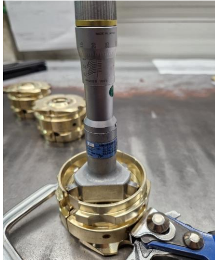
Slika 46: Kontrola promjera 67,18 mm. [24]
