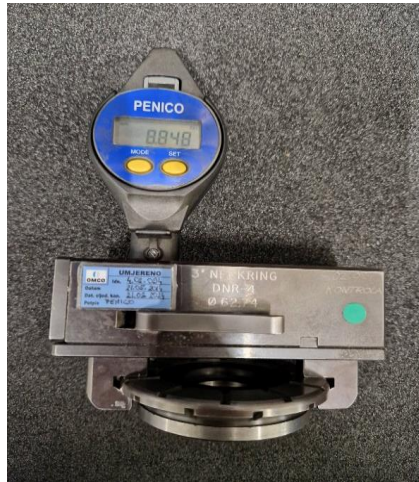
Slika 22: Digitalni kalibar za visinu prizme. [24]
