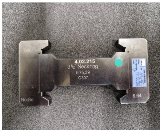
Slika 21: Kalibar za visinu prizme. [24]
