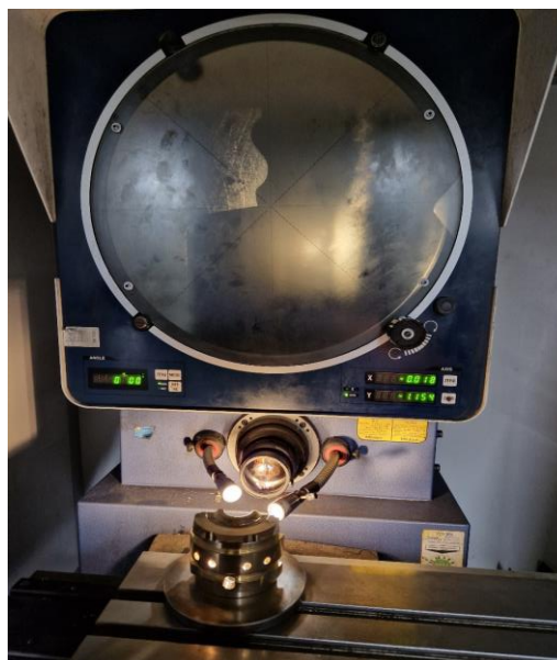
Slika 54: Postavljanje grla na projektor. [24]
