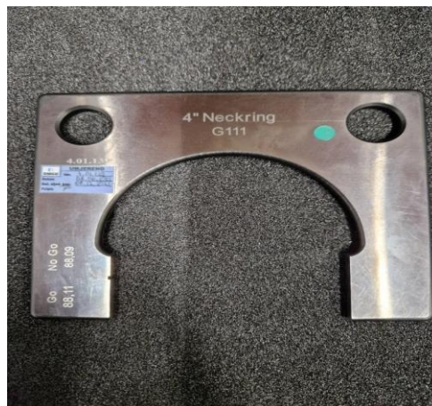
Slika 23: Kalibar za promjer prizme. [24]
