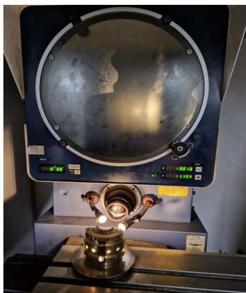
Slika 54: Postavljanje grla na projektor. [24]
