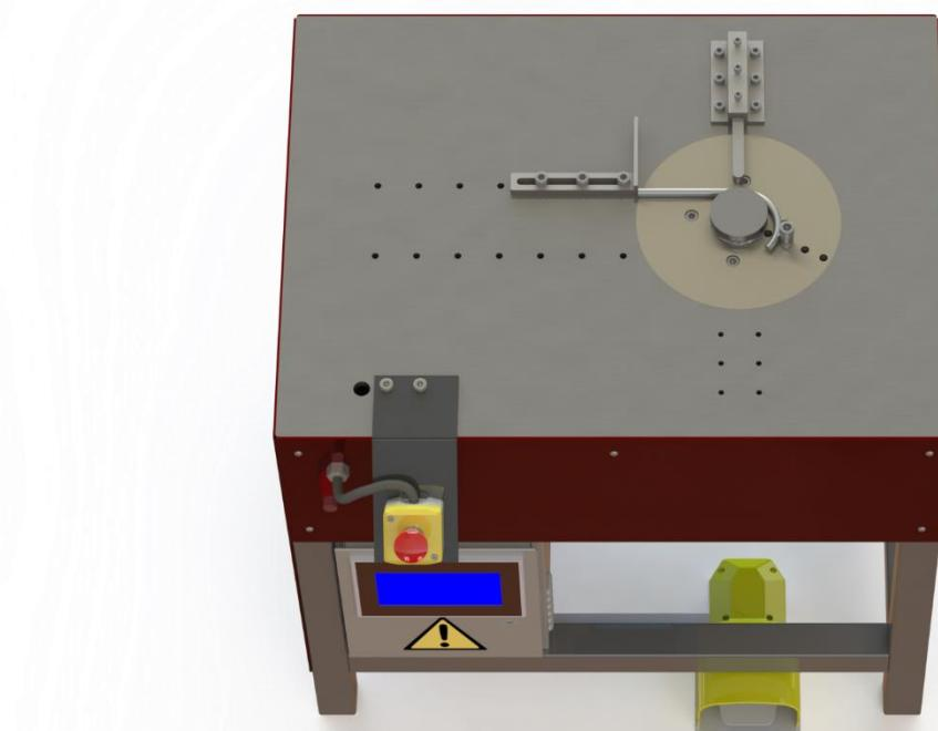
Slika 3.14: Prekidač za brzo isključivanje i nožna sklopka na napravi za savijanje
