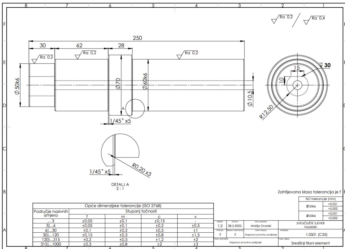
Slika 7.31: Tehnički crtež središnje osovine s tablicom tolerancija
