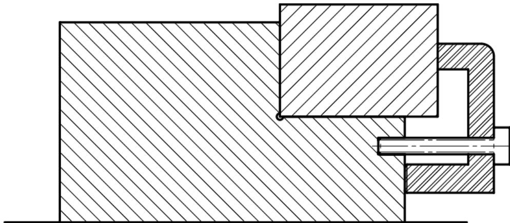
*Slika 3.16: Stezanje obratka pomoću vijka i steznog elementa*
