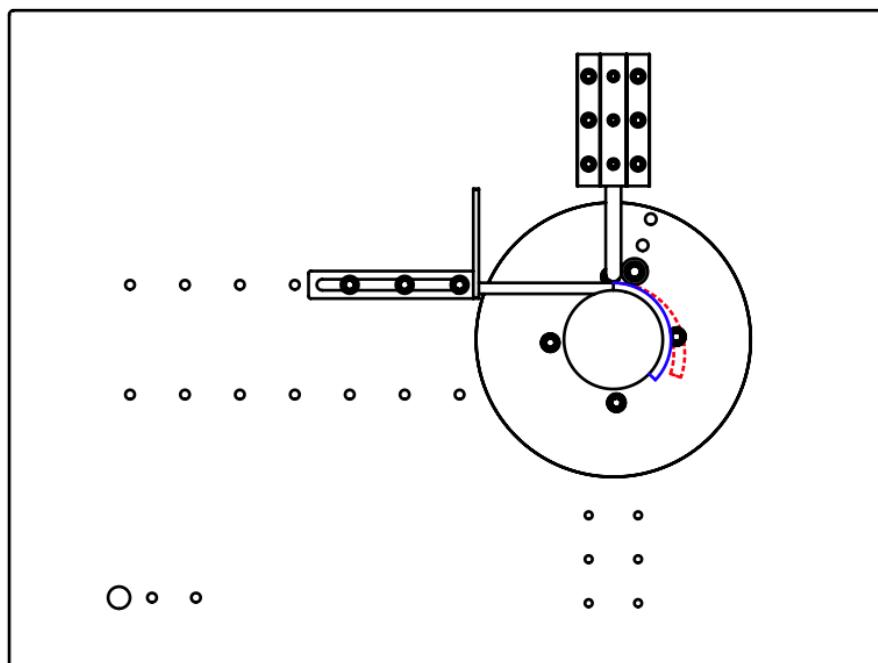
Slika 4.1: Elastični povrat žice u napravi za savijanje
