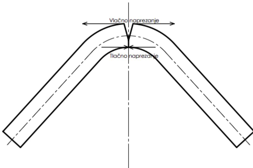
Slika 4.2: Pukotine na vanjskom radijusu savijene žice
