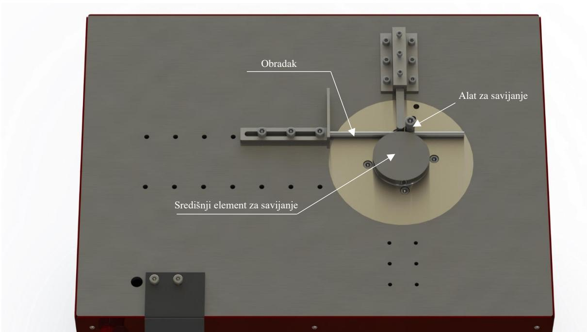
*Slika 3.9: Prikaz izratka u napravi za savijanje*
