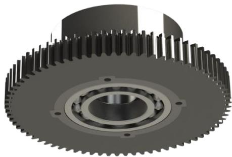
*Slika 3.18: Prikaz spoja vratila i zupčanika oblikom (bez prirubnice)*
