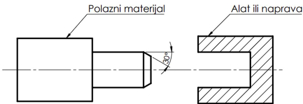
Slika 3.7: Skošenje za lakše umetanje u alat
