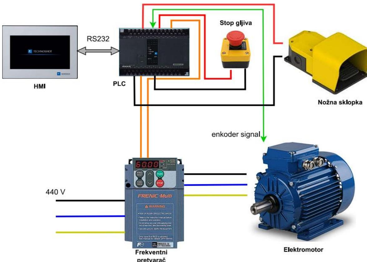
Slika 7.24: Shema spajanja električnih komponenti
