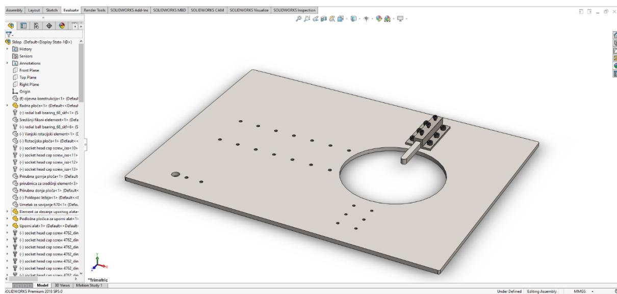
Slika 7.18: Uporni alat stegnut na radnu ploču
