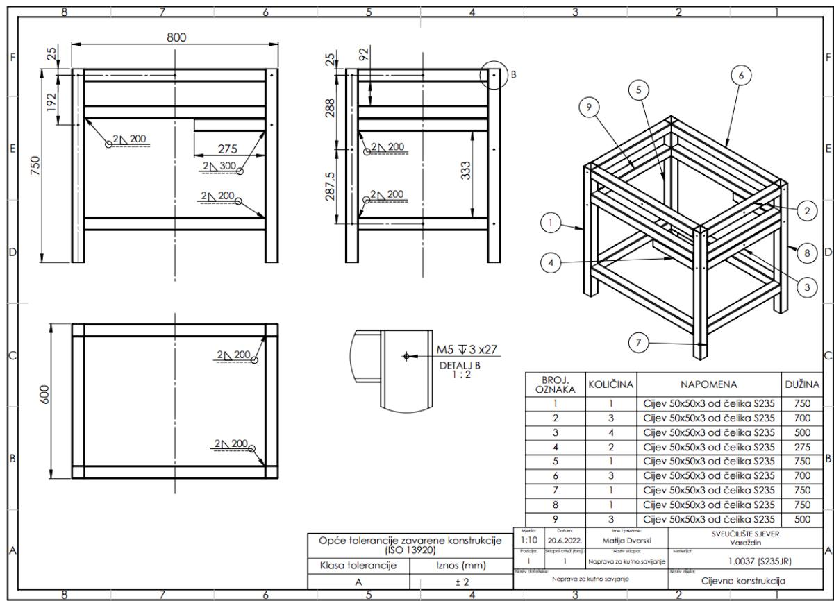
Slika 7.29: Crtež cijevne konstrukcije s tablicom dužine cijevi
