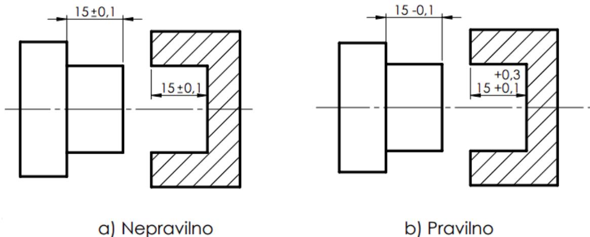
Slika 3.2: Primjer pravilnog i nepravilnog toleriranja čepa
