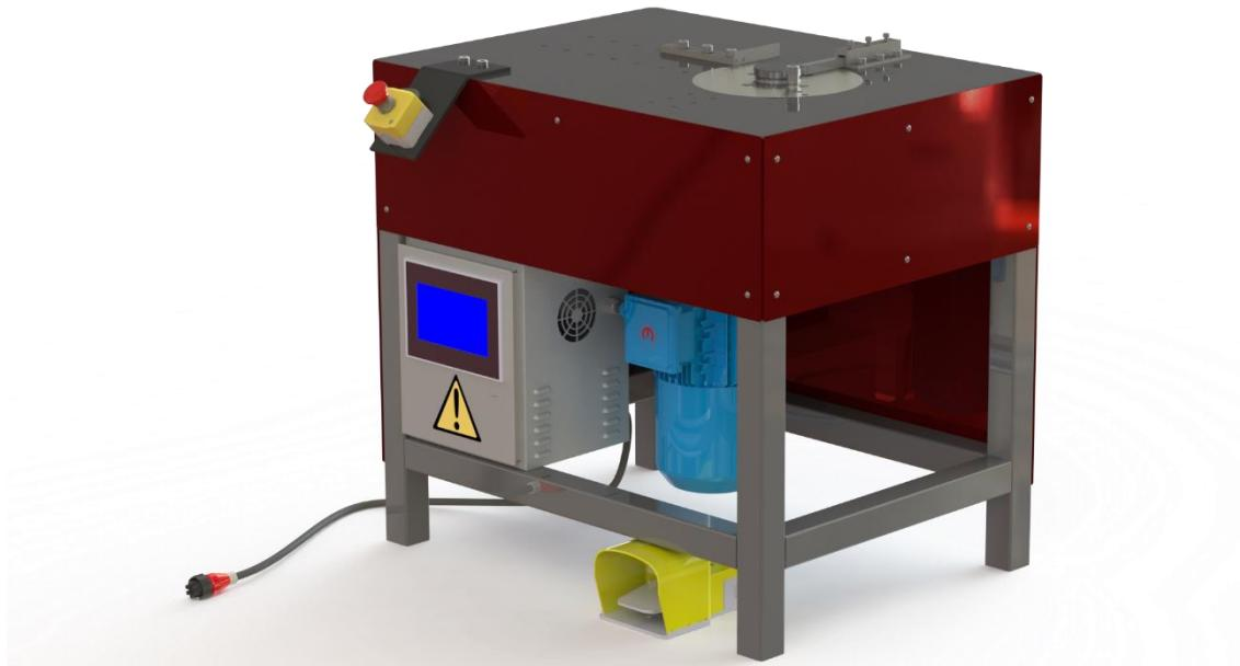
Slika 7.26: Render modela sastavljene naprave za kutno savijanje
