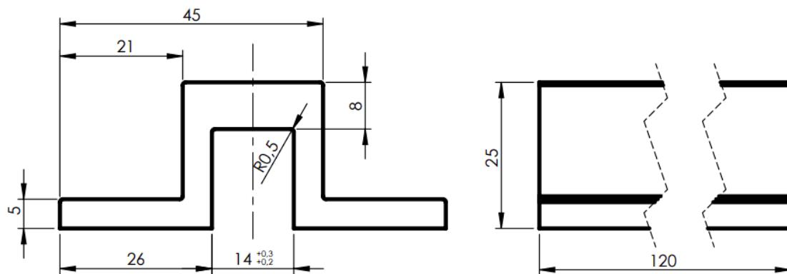
Slika 3.21: Crtež elementa za stezanje upornog alata
