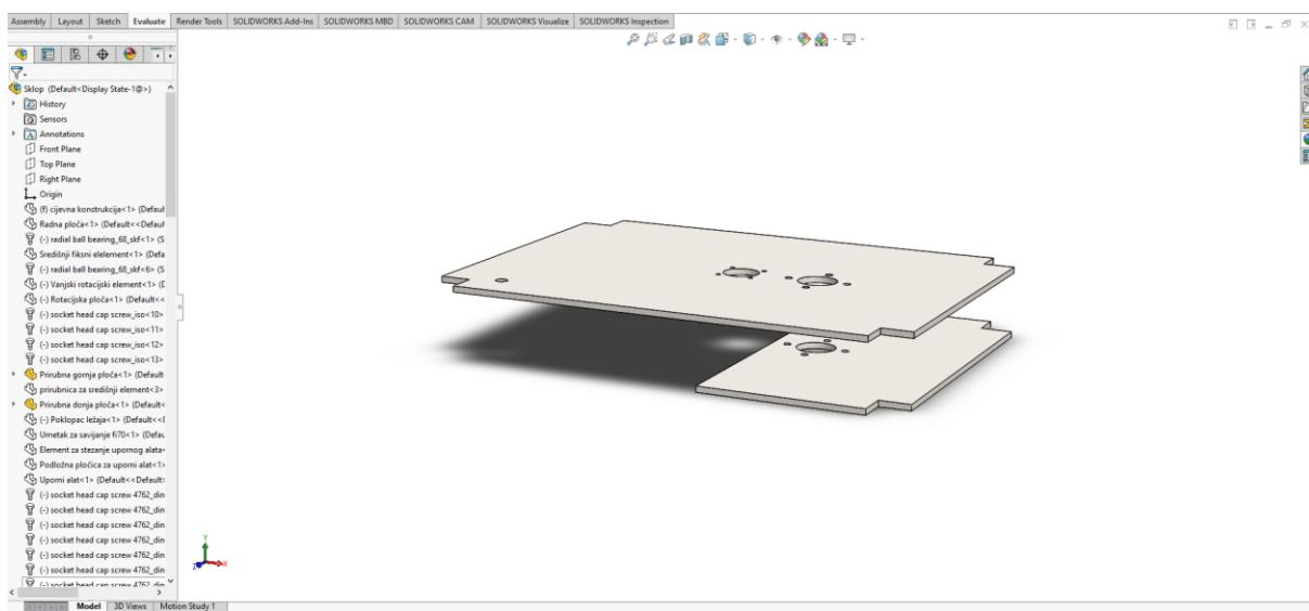
Slika 7.22: Metalne ploče za povećanje krutosti naprave i montažu elemenata
