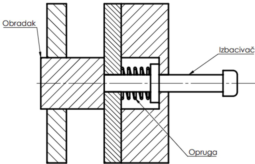
Slika 3.8: Sistem izbacivača s oprugom
