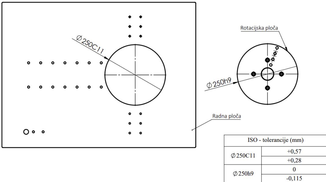
Slika 3.4: Primjer upotrebe tolerancija kod konstruiranja naprave
