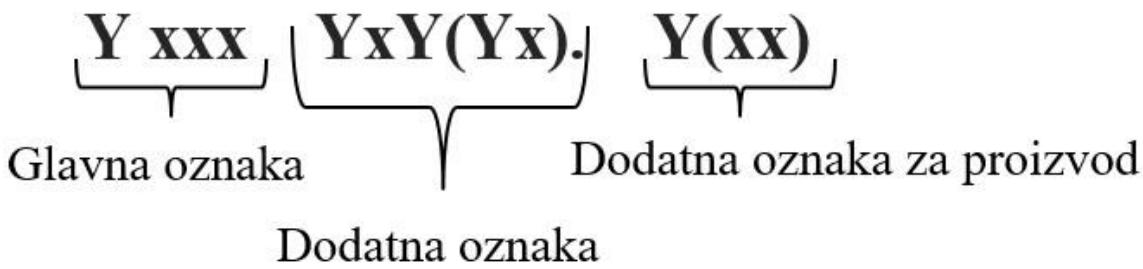
Slika 3.11: Označavanje čelika prema EN normi [6]
