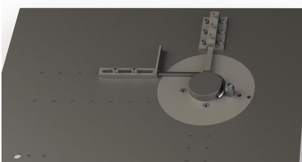
Slika 3.17: Prikaz stegnutog obratka u procesu savijanja
