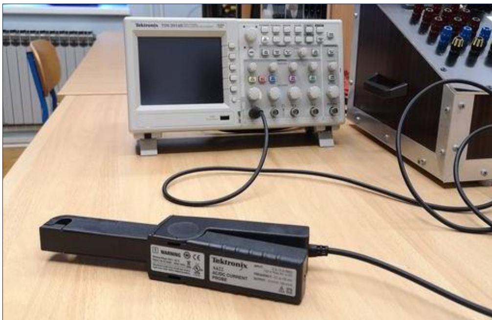
Slika 52. Osciloskop i strujna kliješta Tektronix
