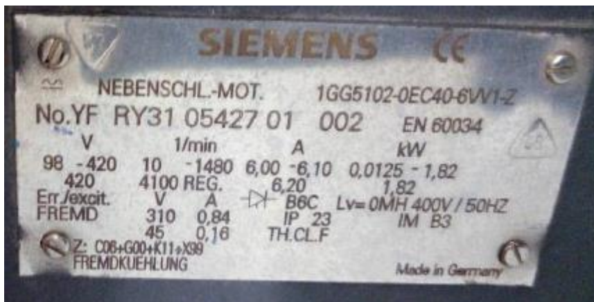
Slika 23. Nazivna pločica prvog motora
