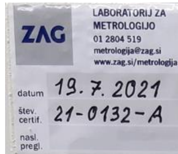
Slika 13. Primjer naljepnice umjeravanja vanjskog umjernog laboratorija [13]
