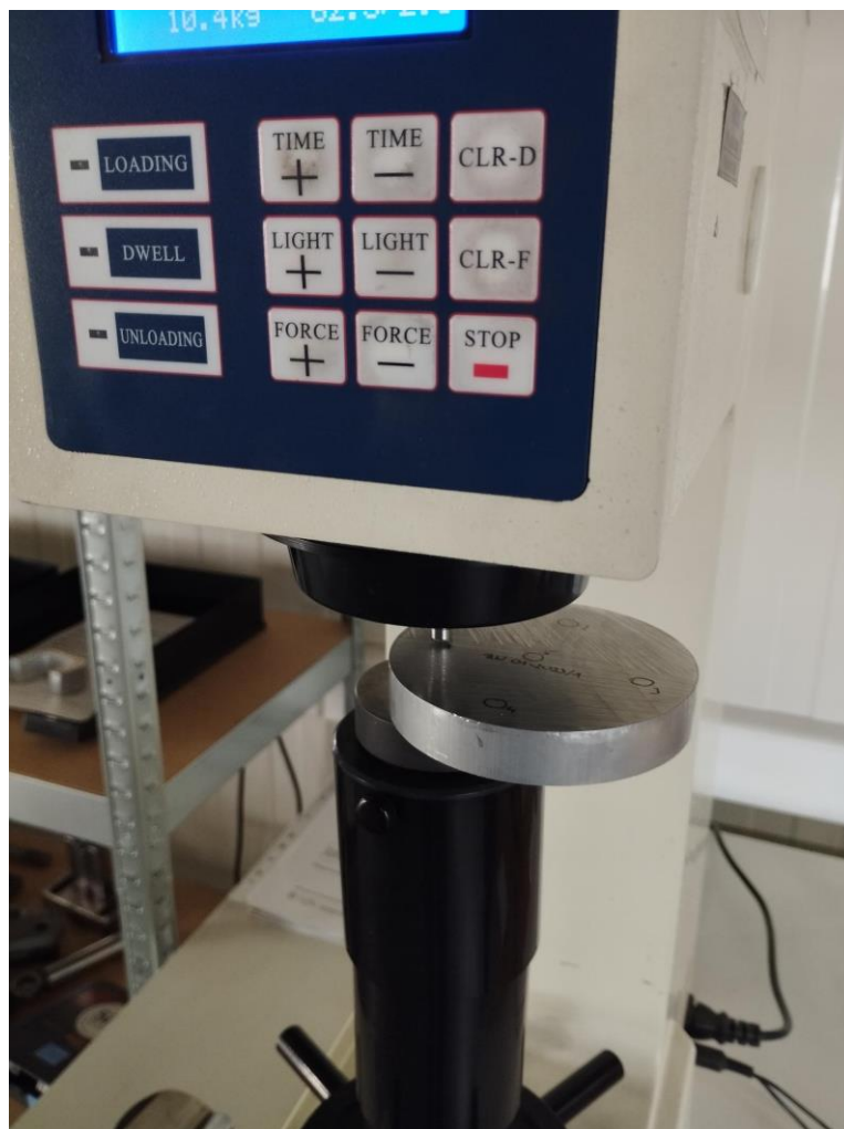
Slika 42. Primjer ispitivanja na tvrdomjeru [13]
