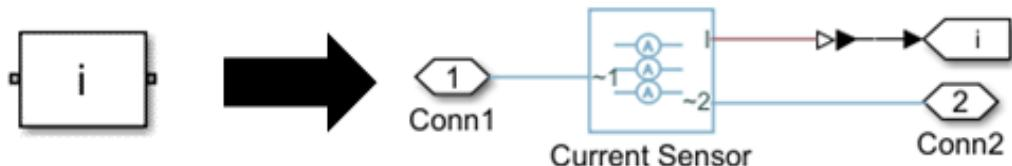
Slika 13: Senzor struje
