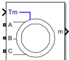
Asynchronous Machine SI Units – implementira trofazni asinkroni stroj, u ovom slučaju kavezni
