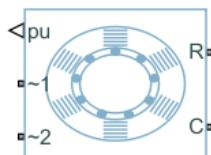
Asyncronous machine squirrel cage – induksijski motor s kaveznim rotorom
