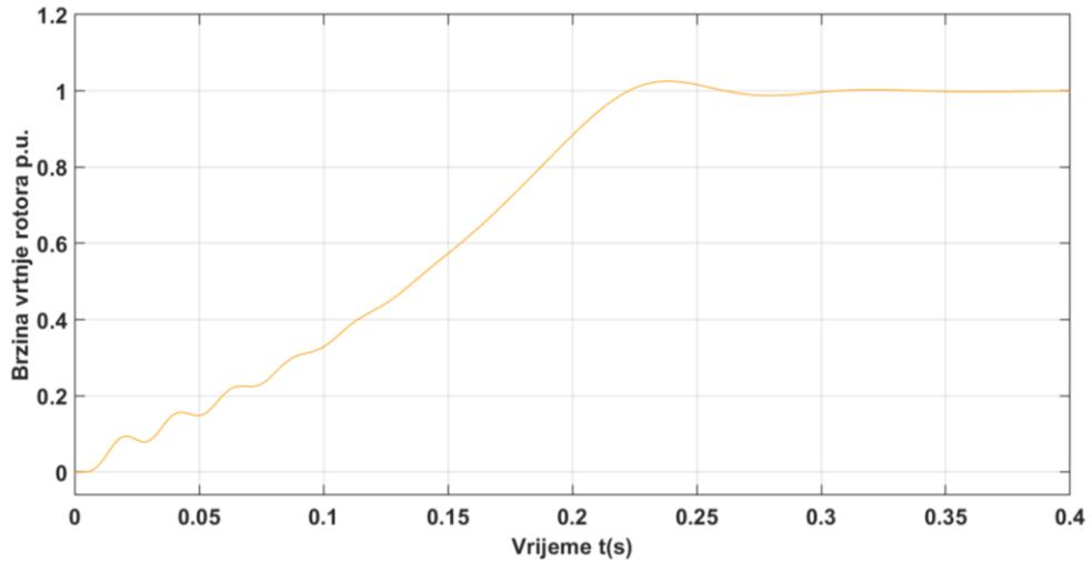
Slika 19: Model 1 – zalet, brzina rotora – motor 600 W
