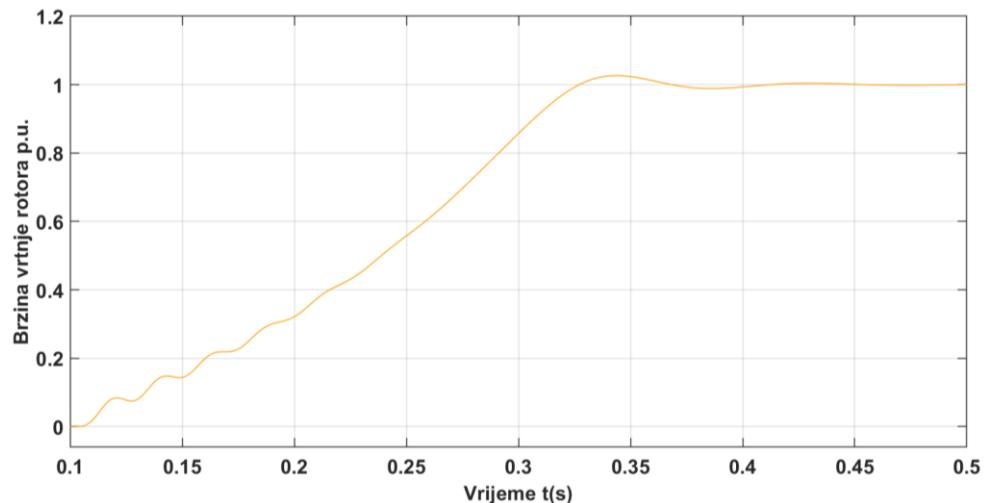
Slika 20: Model 2 – zalet, brzina rotora – motor 600 W
