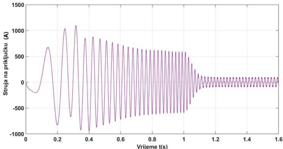
Slika 57: Model 3 – zalet metodom U/f, struja na stezalkama – 1250 kW
