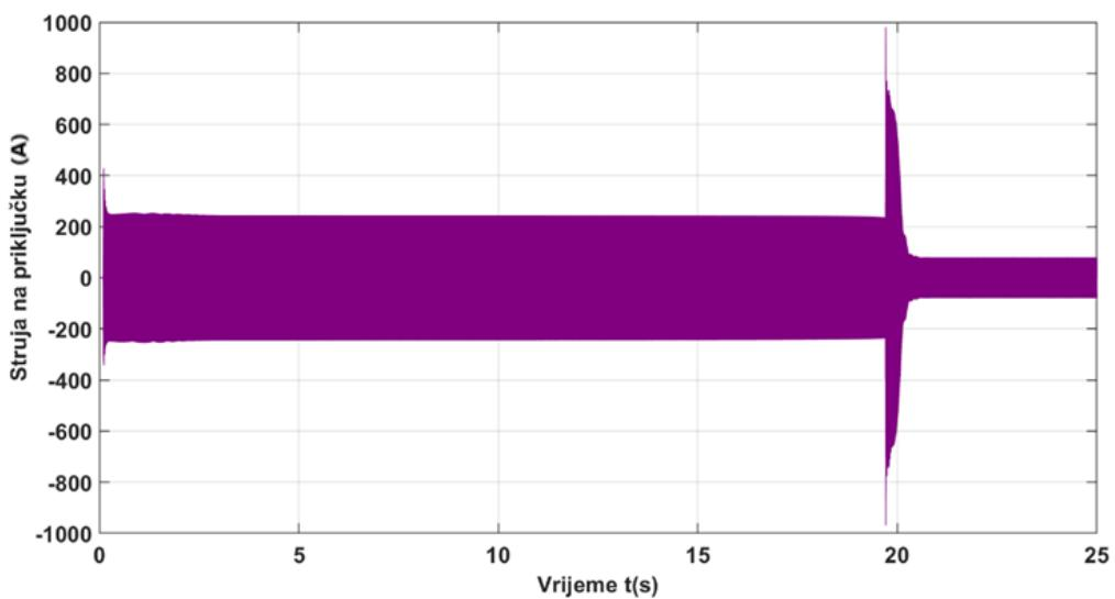
Slika 55: Model 2 – zalet Y-Δ, struja na stezalkama – motor 1250 kW
