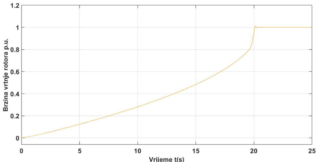
Slika 52: Model 2 – zalet Y-Δ, brzina rotora – motor 1250 kW
