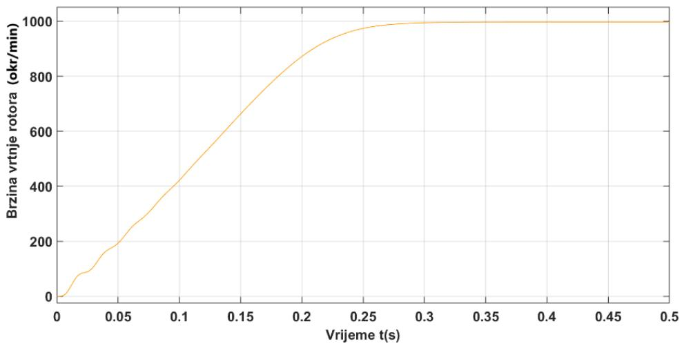
Slika 21: Model 3 – zalet, brzina rotora – motor 600 W
