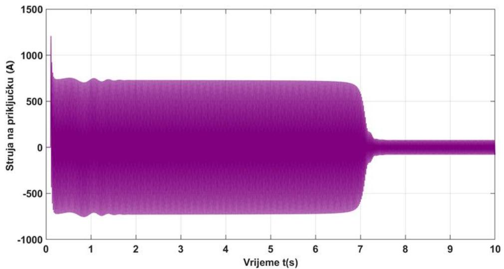
Slika 50: Model 2 – direktni zalet, struja na stezaljkama – motor 1250 kW
