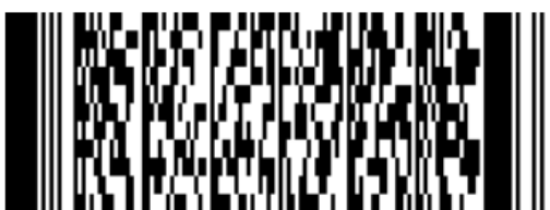
Slika 6: PDF417 2D barkod Izvor [22]
