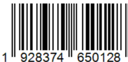
Slika 5: EAN-13 1D barkod Izvor [20]
