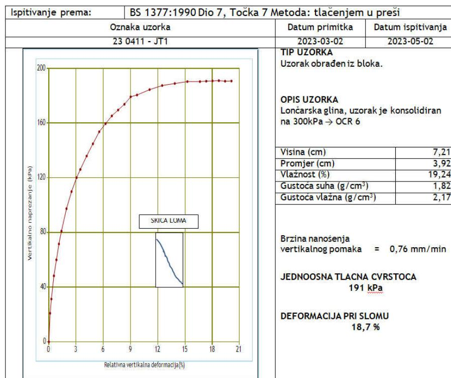
Slika 58.: Izvještaj o ispitivanju jednoosne tlačne čvrstoće,
