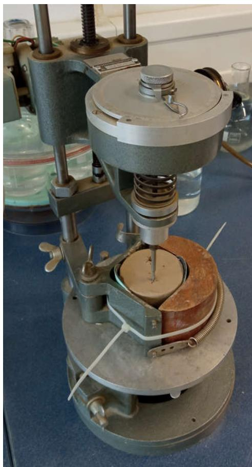
Slika 27.: Laboratorijska krilna sonda,
