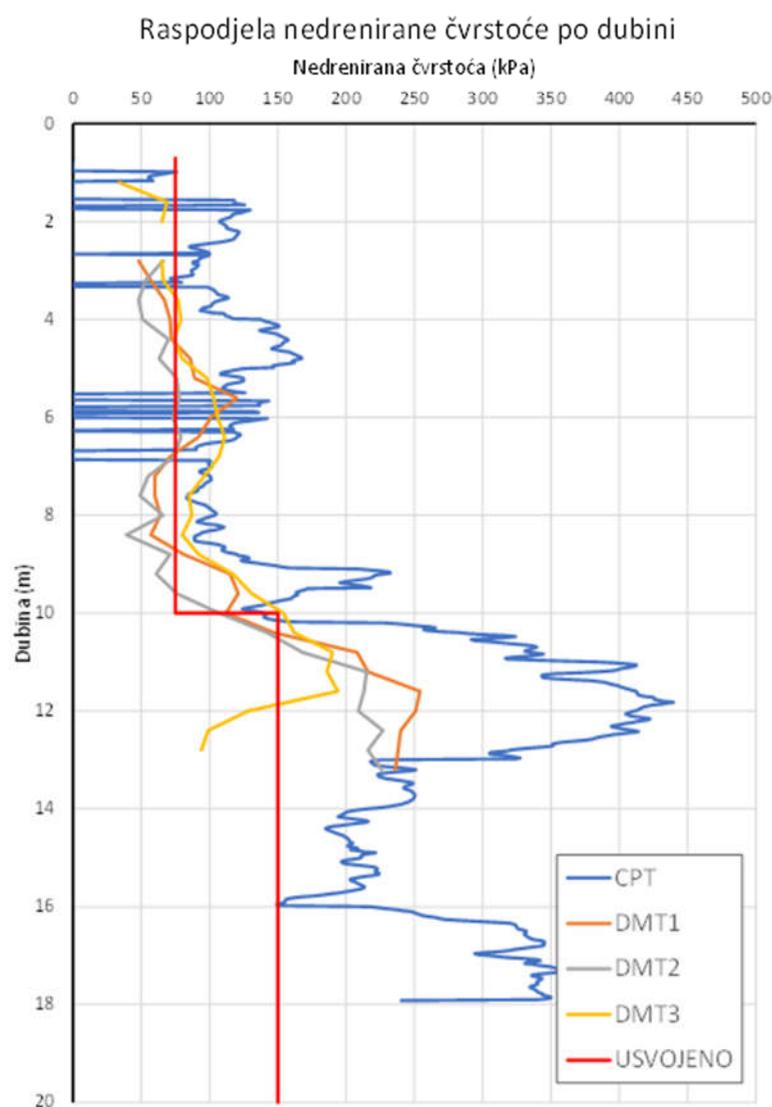
Slika 79.: Primjer raspodjele nedrenirane čvrstoće po dubini [6]
