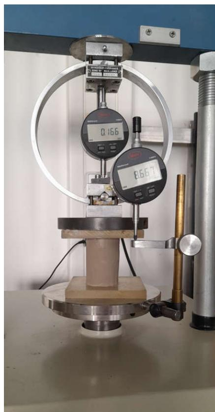
Slika 33.: Ispitivanje uzorka u preši,
