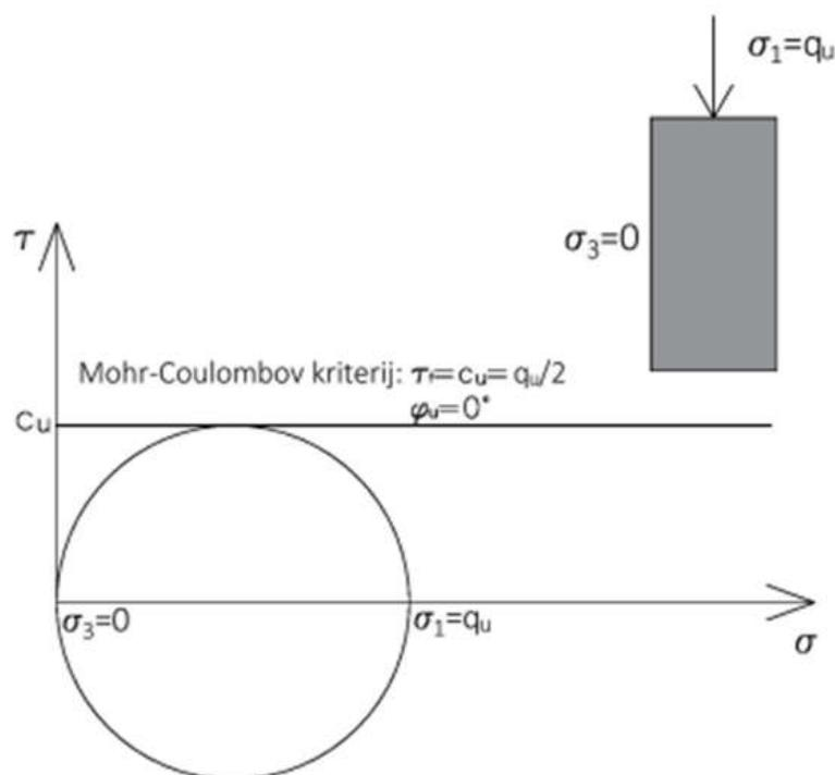
Slika 44.: Prikaz Mohrove kružnice za uzorak ispitivan pokusom jednoosne tlačne čvrstoće, preuzeto iz [12]
