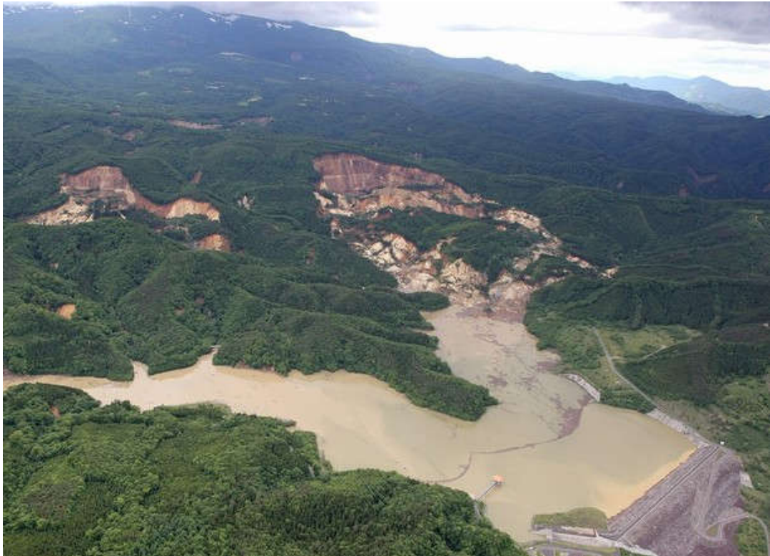
Slika 18.: Klizište u blizini Aratozawa brane u Japanu nastalo kao rezultat potresa Iwate-Miyagi, magnitude 6.9, iz 2008. godine [13]
