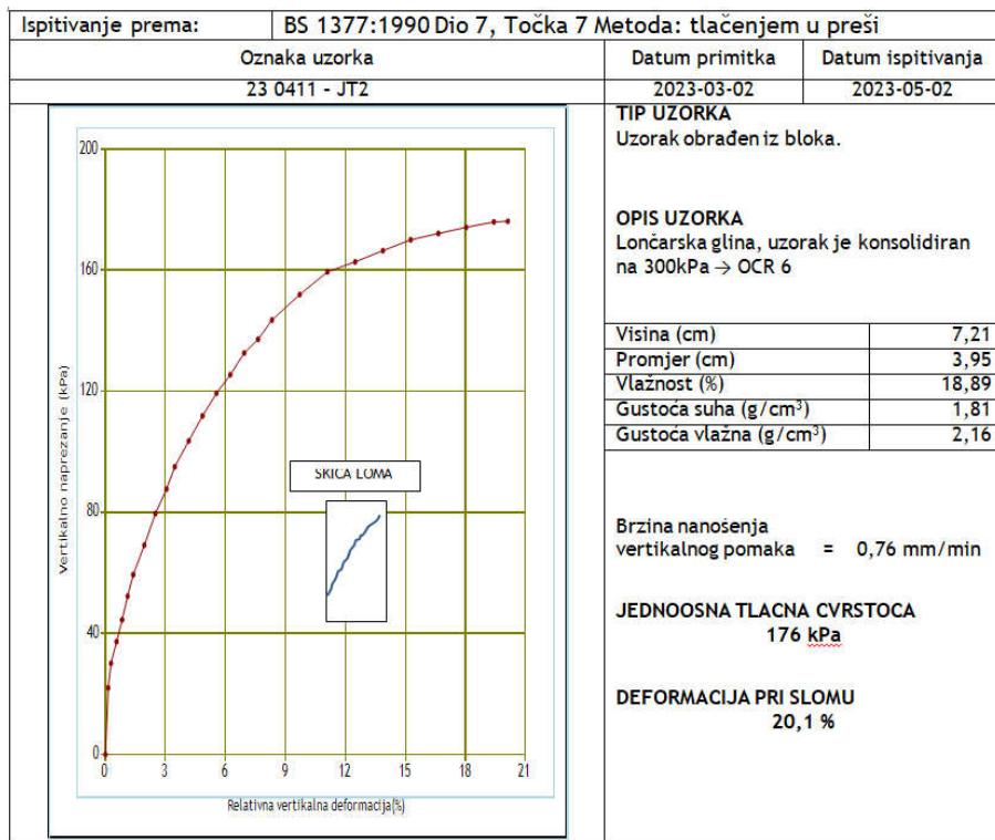
Slika 59.: Izvještaj o ispitivanju jednoosne tlache čvrstoće, (skenirano uz dozvolu IGH, 2023.)
