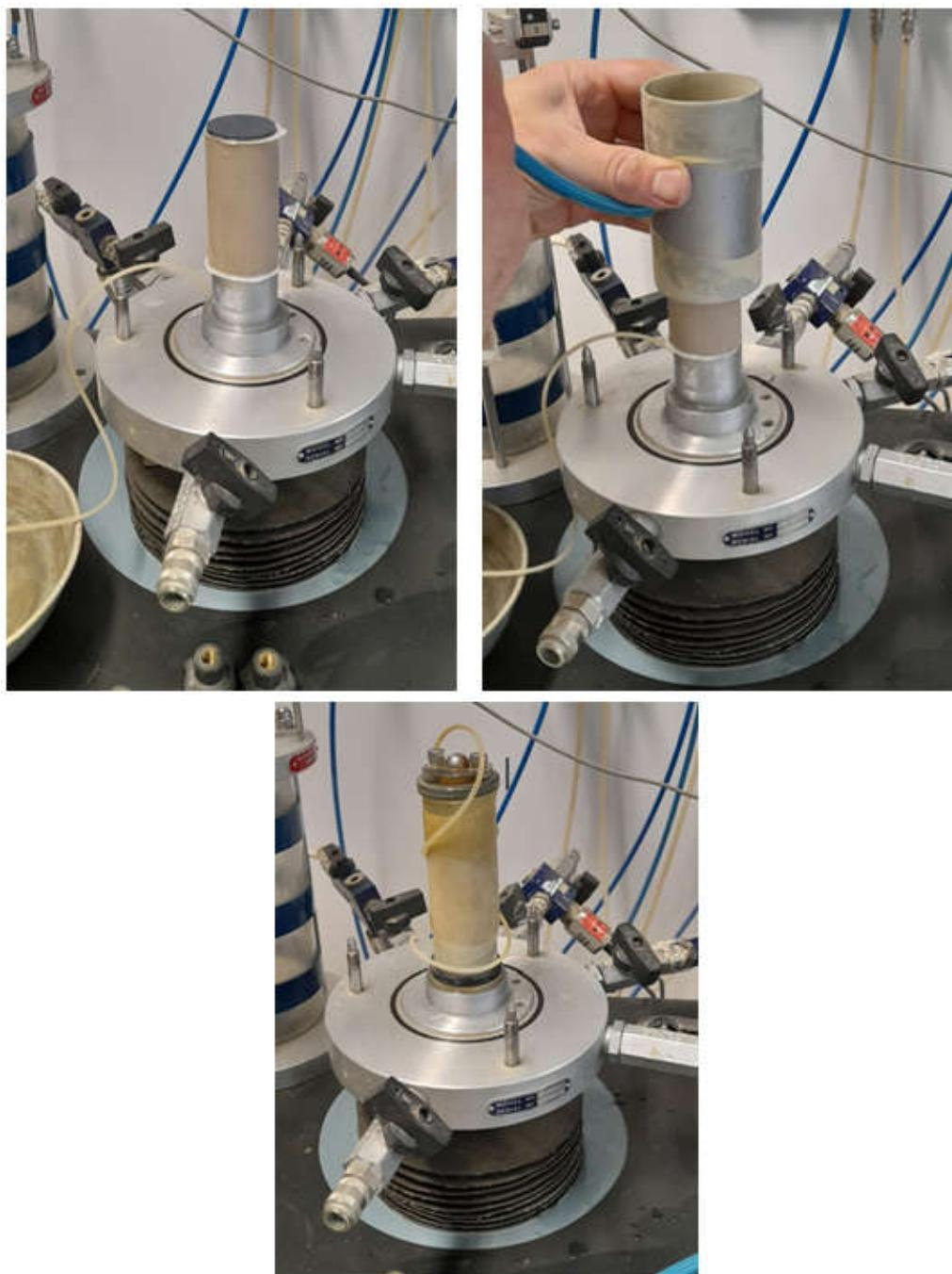
*Slika 41.: Postupak ugradnje uzorka u ćeliju,
