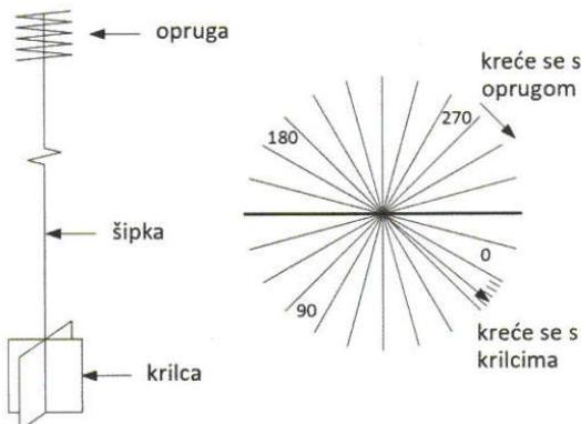
Slika 6. Princip ispitivanja laboratorijskom krilnom sondom [2]
