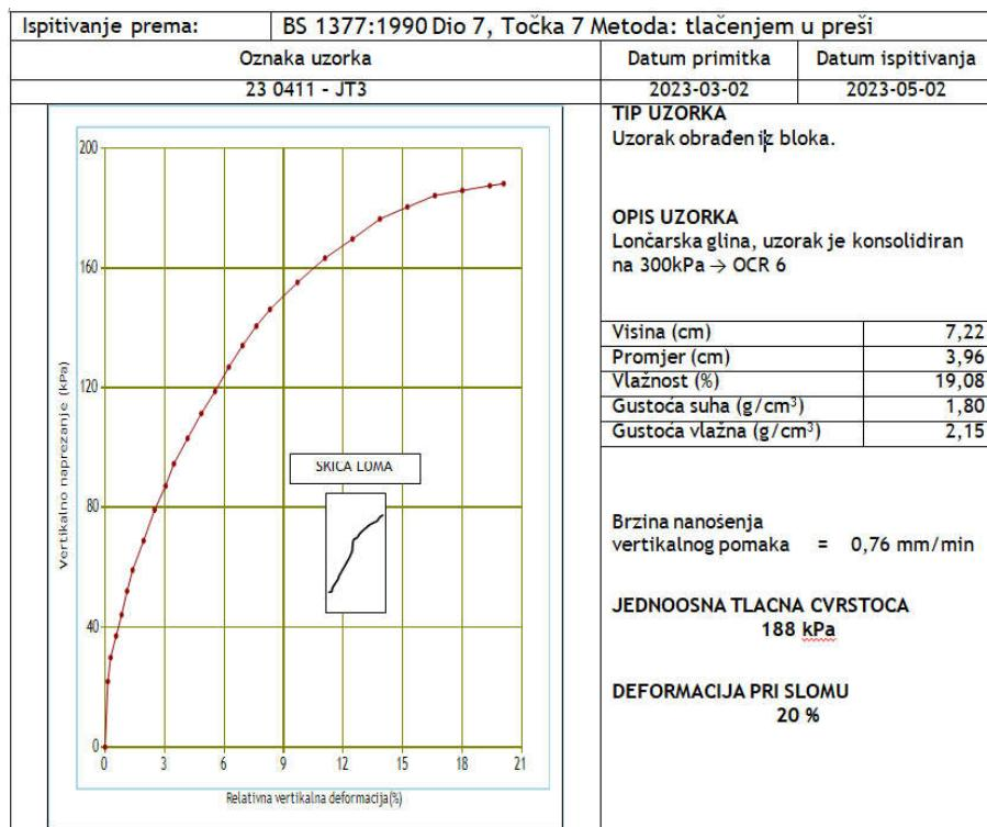
Slika 60.: Izvještaj o ispitivanju jednoosne tlache čvrstoće, (skenirano uz dozvolu IGH, 2023.)
