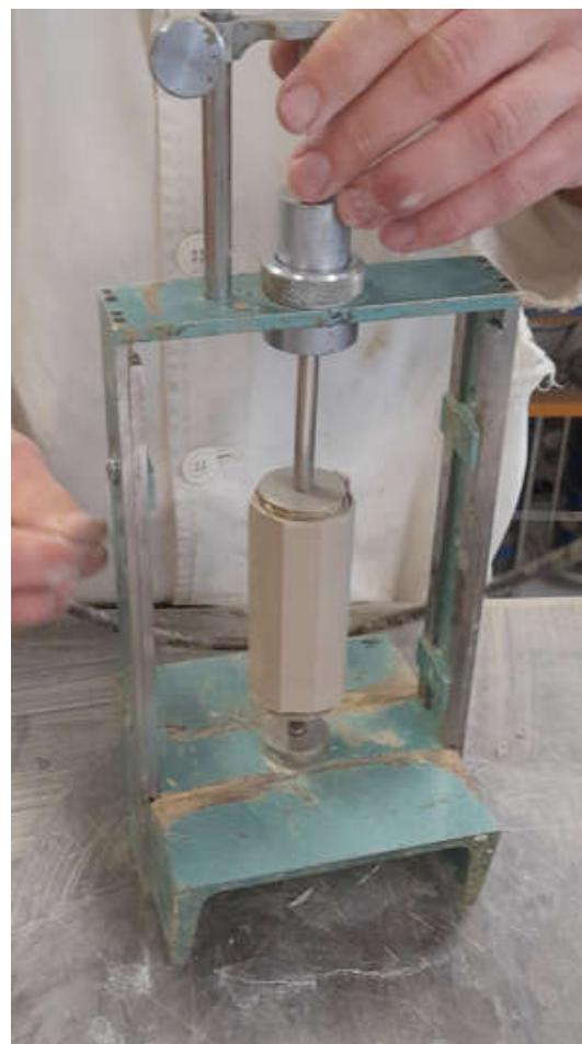
*Slika 40.: Obrada uzorka u trimeru,
