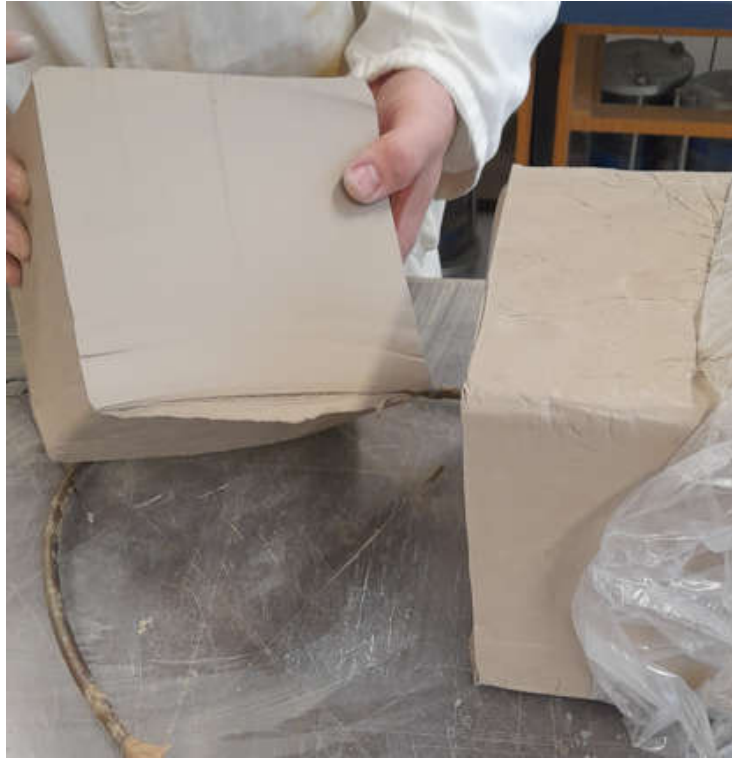
Slika 45.: Uzorak homogene gline korišten za potrebe ispitivanja, (fotografirano uz dozvolu IGH, 2023.)
