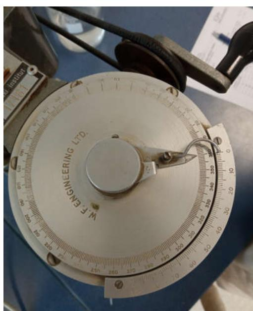
Slika 28.: Laboratorijska krilna sonda-mjerač kuta,
