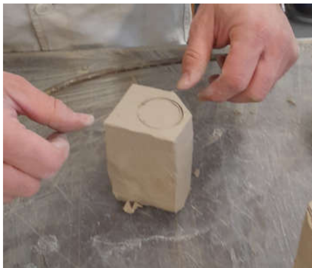
Slika 39.: Obrada uzorka pomoću tanke žice, (fotografirano uz dozvolu IGH, 2023.)
