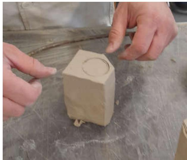
*Slika 39.: Obrada uzorka pomoću tanke žice,
