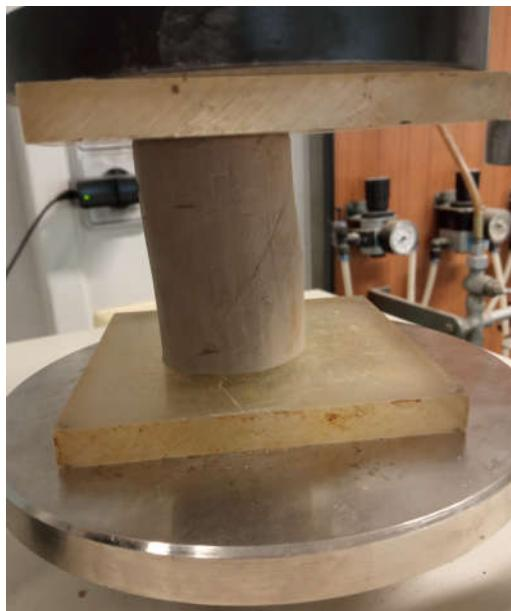
Slika 34.: Uzorak nakon ispitivanja sa vidljivom kliznom plohom,
