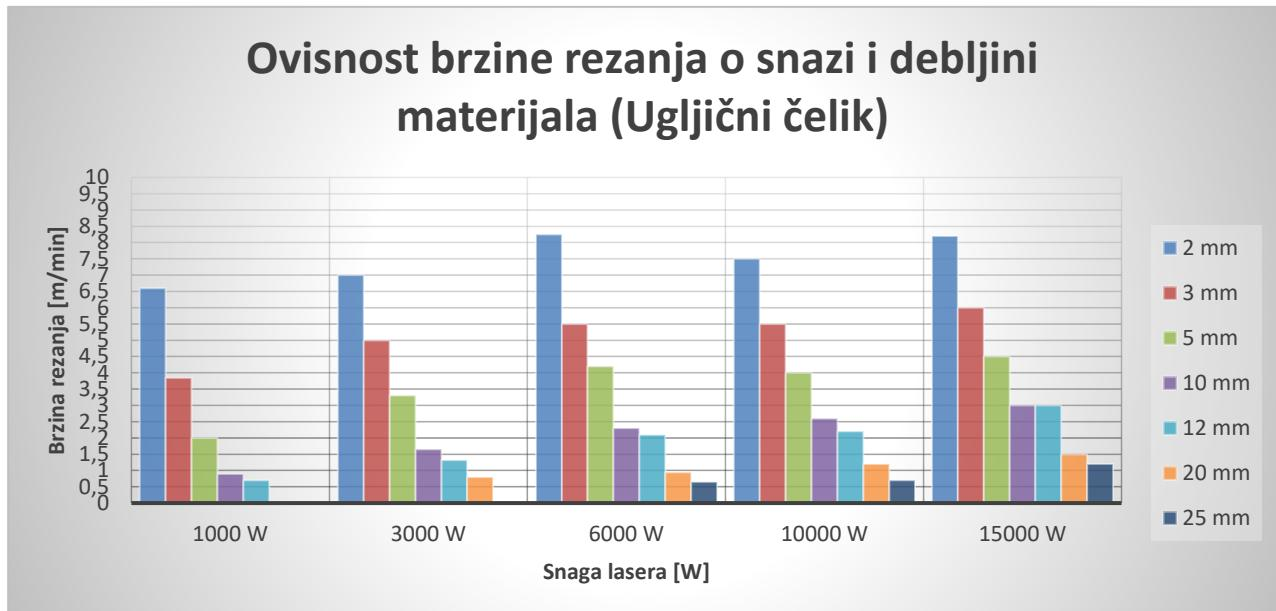
Slika 17: Ovisnost brzine rezanja o snazi i debljini materijala za ugljični čelik (IPG fiber laser) [19]
