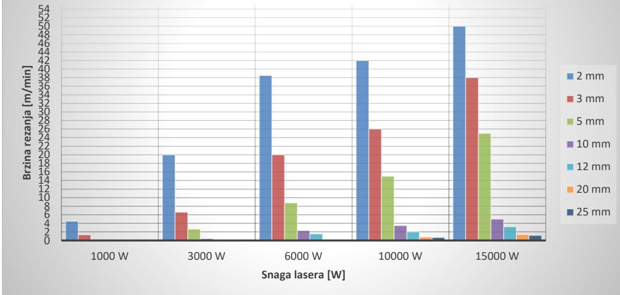
Slika 19: Ovisnost brzine rezanja o snazi i debljini materijala za aluminij (IGP fiber laser) [19]
