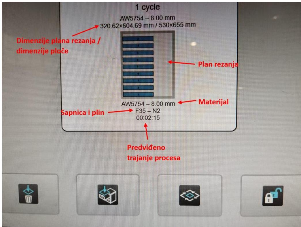
Slika 40: Program rezanja učitan na radnom računalu lasera
