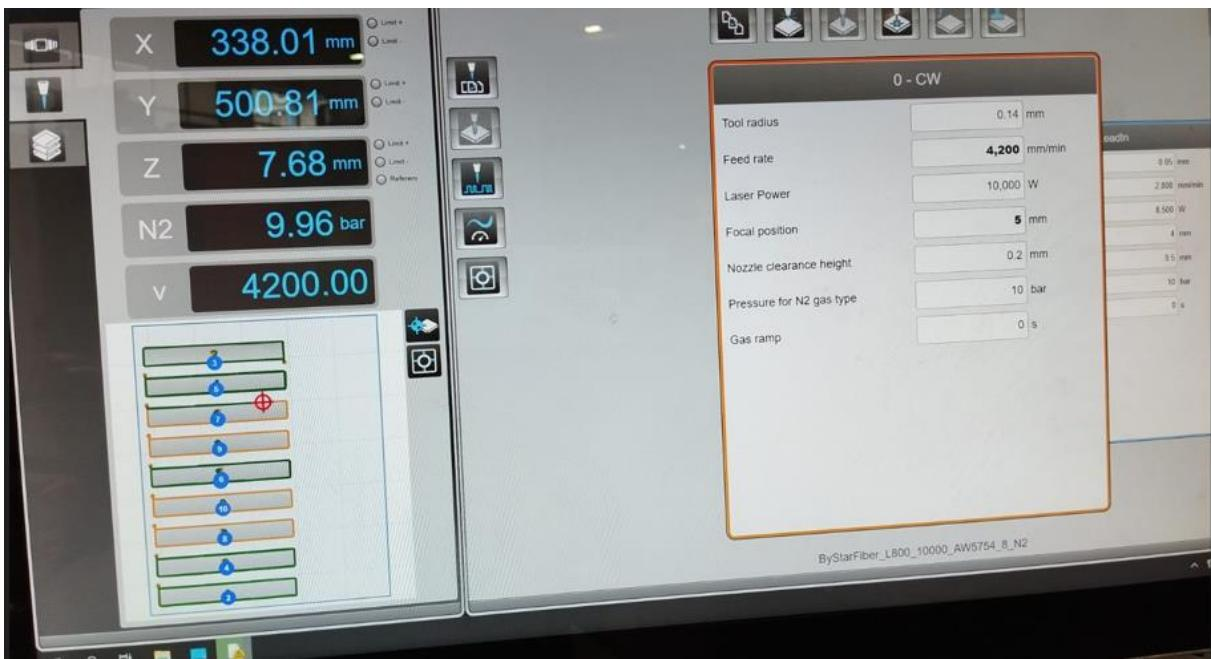
Slika 43: Sučelje radnog računala u trenutku rezanja uzorka 6
