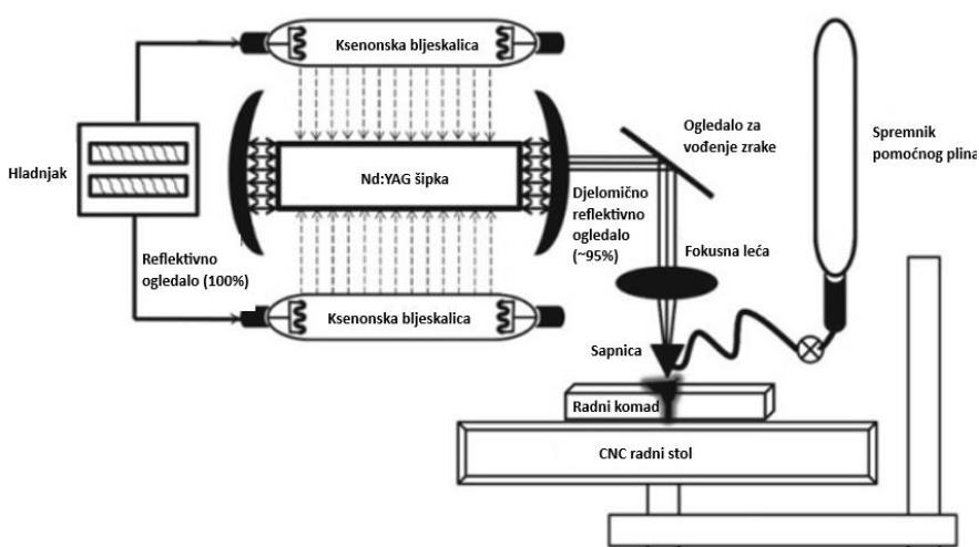
Slika 24: Shematski prikaz moguće izvedbe Nd:YAG lasera [22]
