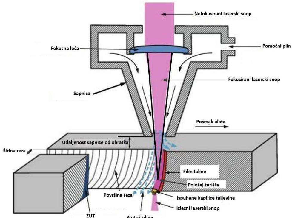
Slika 16: Shematski prikaz postupka laserskog rezanja [16]
