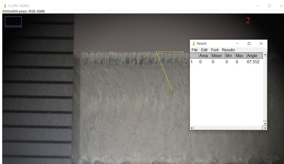
Slika 51: Postupak mjerjenja kutova na reznoj površini
