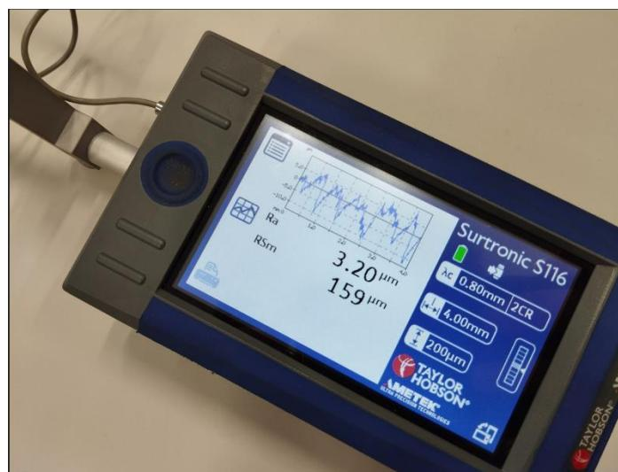
Slika 48: Mjerni uređaj Taylor Hobson S-100
