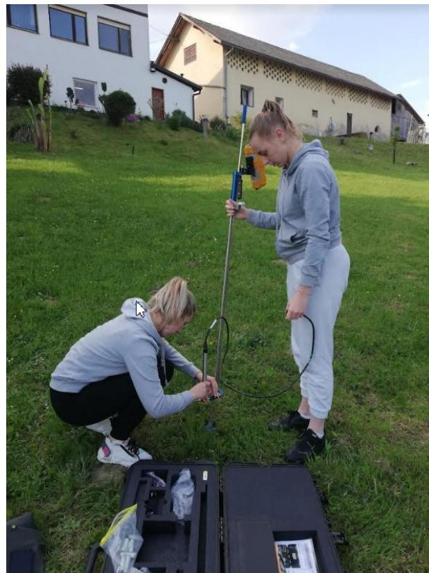
*Slika 11:* Mjerni uređaj i sonda, sklapanje uređaja [15]
