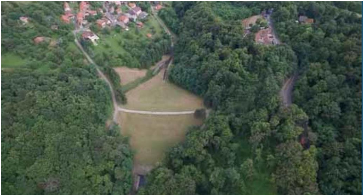
Slika 2: Primjer čeonih retencija – Retencija Lagvić [7]
