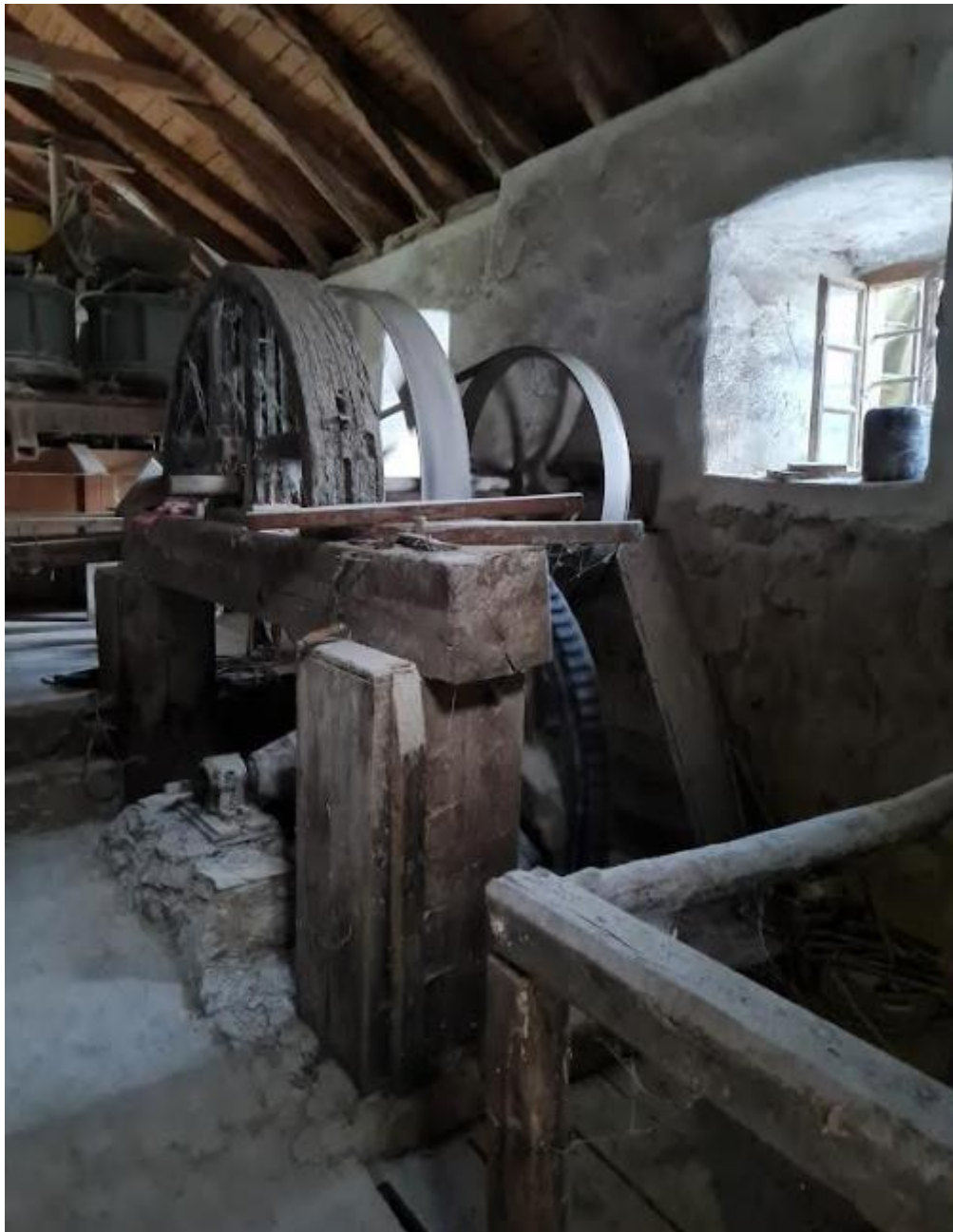
Slika 45. Prijenos vrtnje s mlinskog kola na kameni žrvanj [8]
