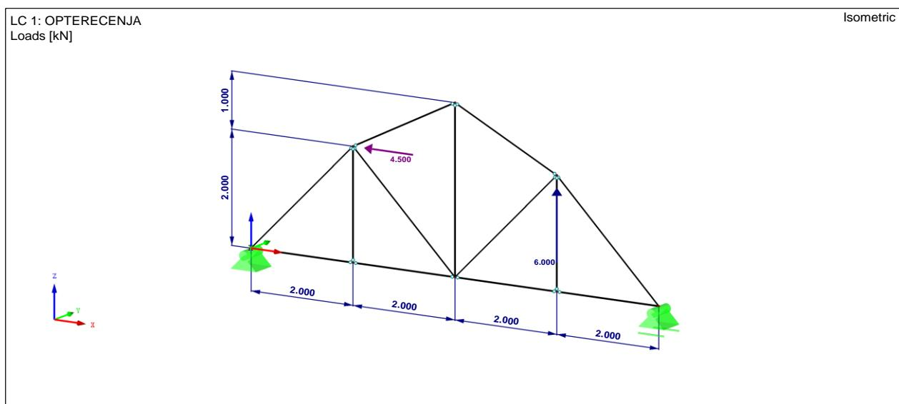
Slika 4.8. Opterećenja na rešetkasti nosač – izometrija
