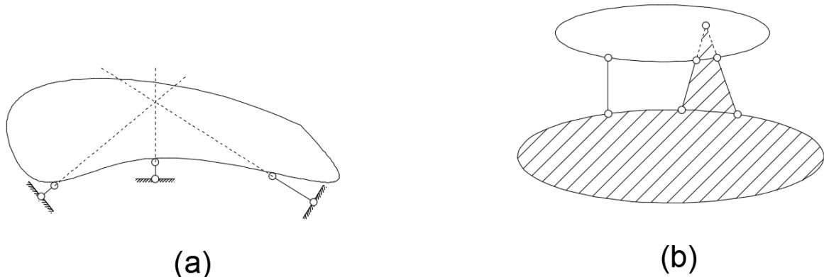
Slika 1.12. *Primjer geometrijski stabilnog i nestabilnog sustava*
