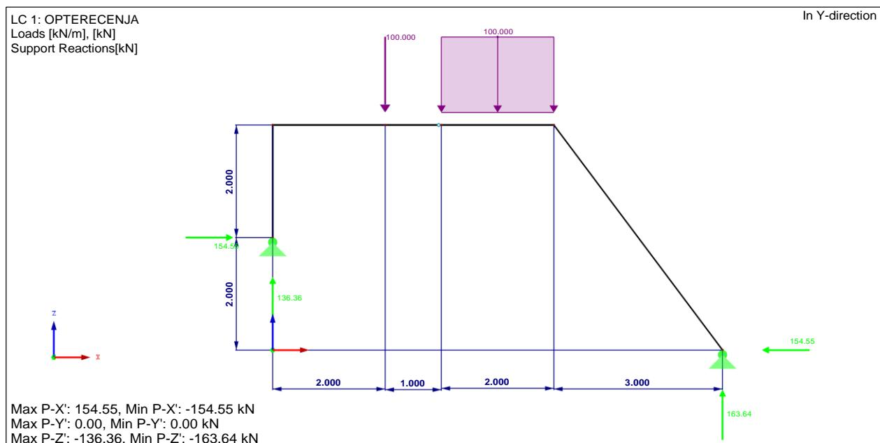
Slika 4.4. Opterećenja na trozglobni nosač – iznos reakcijskih sila
