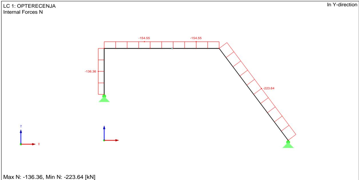
Slika 4.5. Opterećenja na trozglobni nosač – iznos uzdužnih sila
