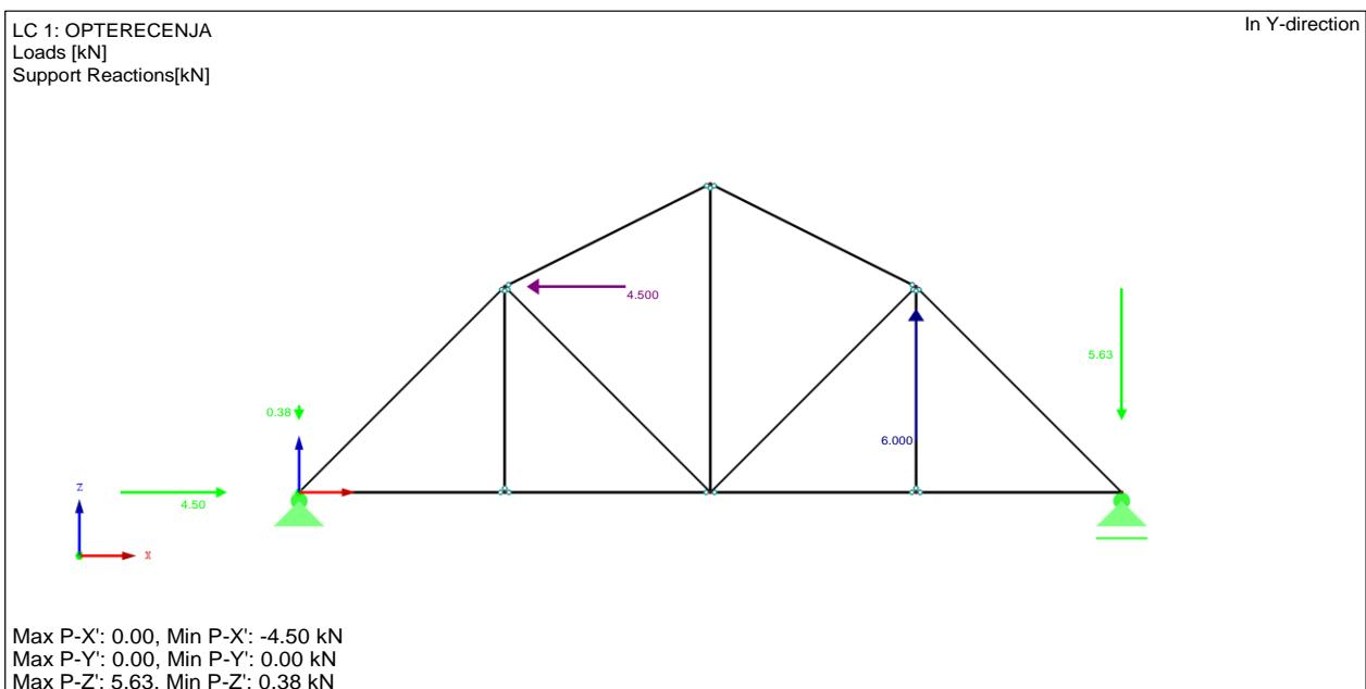
Slika 4.10. Opterećenja na rešetkasti nosač – iznos reakcijskih sila
