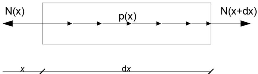
Slika 2.2. Infinitezimalni odsječak između poprečnih presjeka kroz točke  $x$  i  $x+dx$
