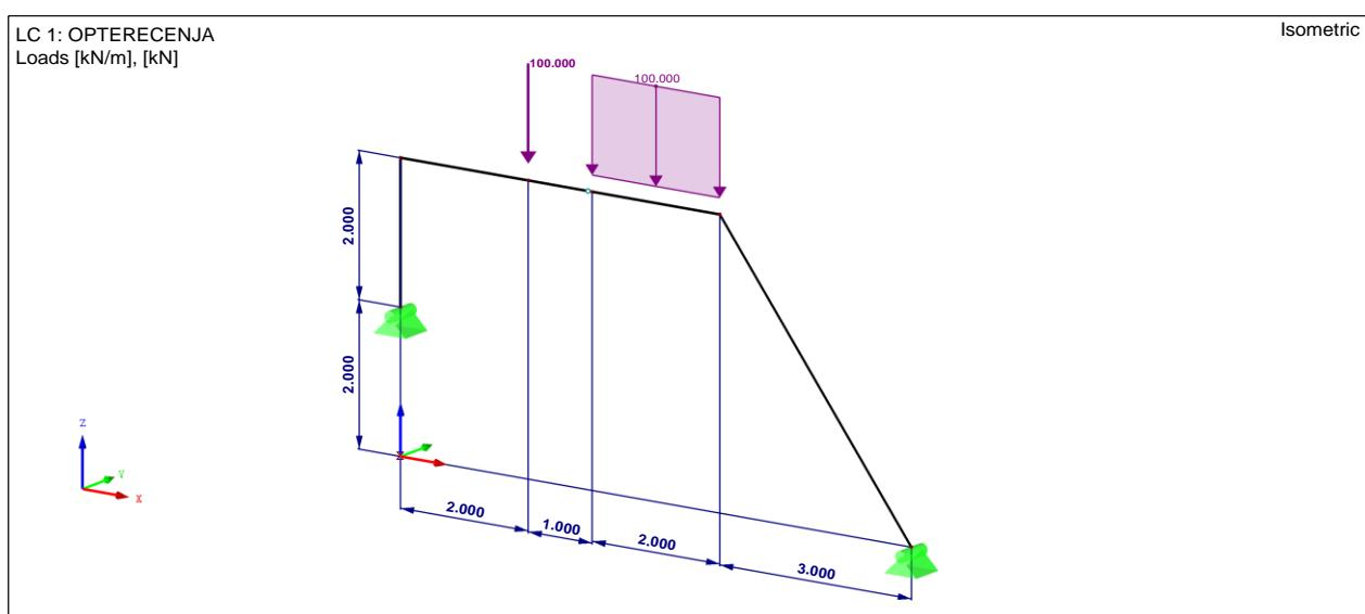
Slika 4.2. Opterećenja na trozglobni nosač - izometrija
