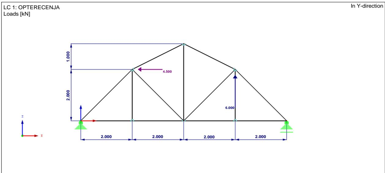
Slika 4.9. Opterećenja na rešetkasti nosač – djelovanja u y smjeru
