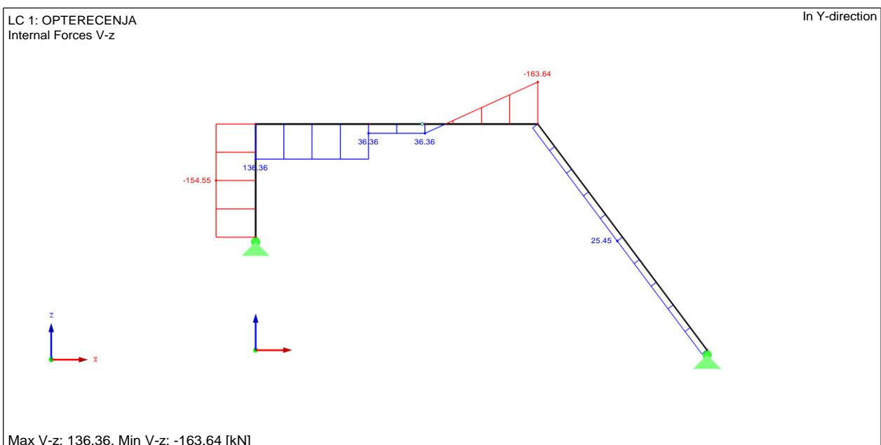
Slika 4.6. Opterećenja na trozglobni nosač – iznos poprečnih sila
