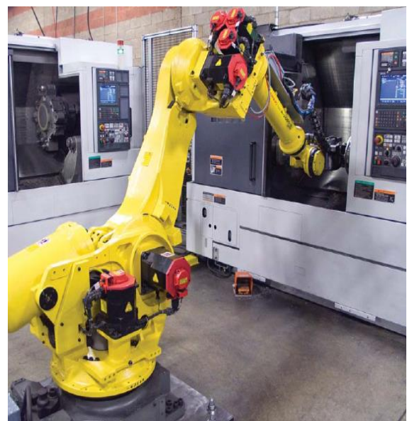
Slika 5. Primjer fleksibilne tokarske obradne ćelije s robotom [8]
