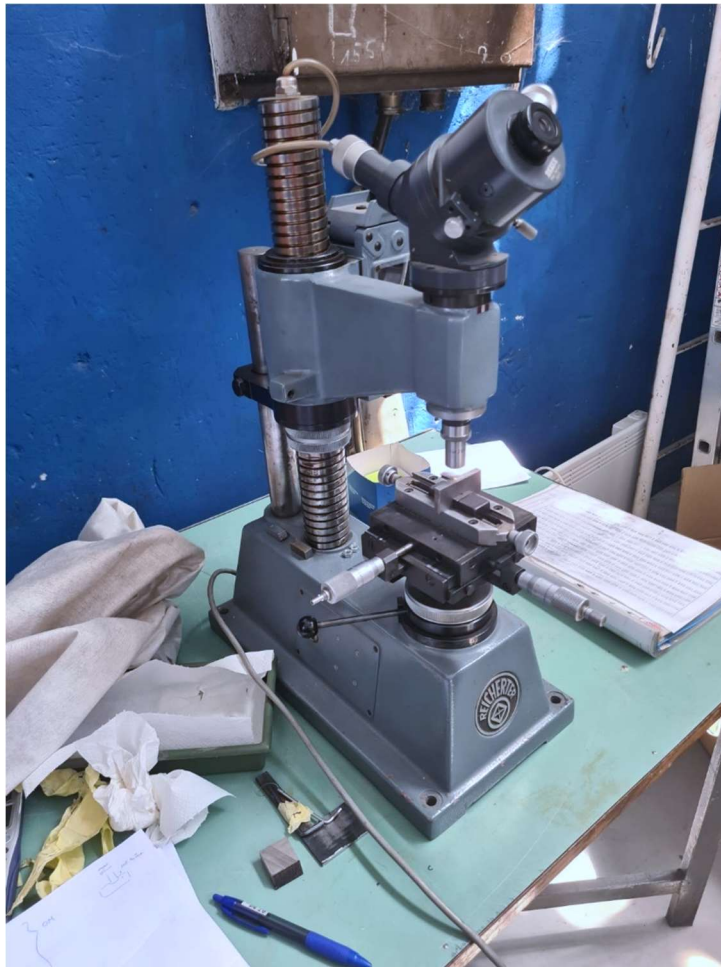
Slika 4.32. Uređaj za mjerenje tvrdoće
