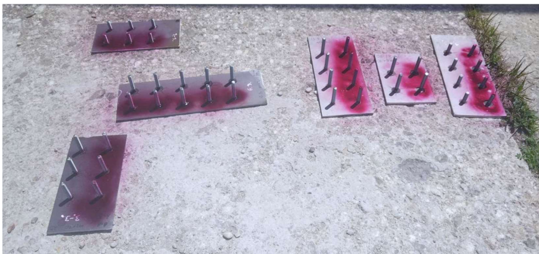
Slika 4.35. Naneseni crveni penetrant na ispitne ploče
