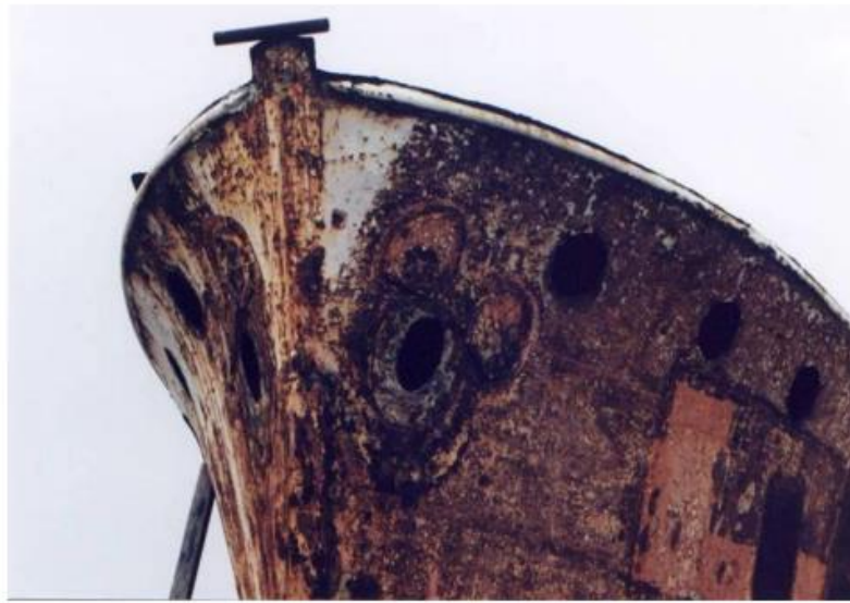
Slika 7 Opća korozija na čeličnoj oplati trupa broda [10]
