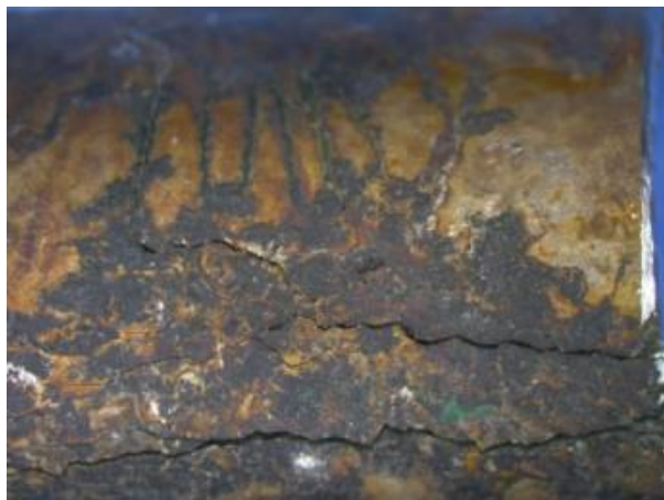
Slika 13 Transkristalna napetosna korozija [10]
