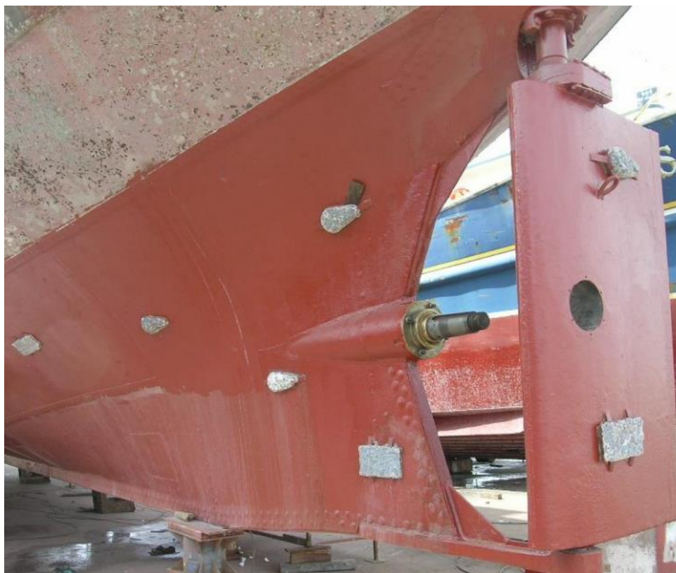
Slika 31 Zaštita brodskog trupa protektorskim anodama od cinka [13]
