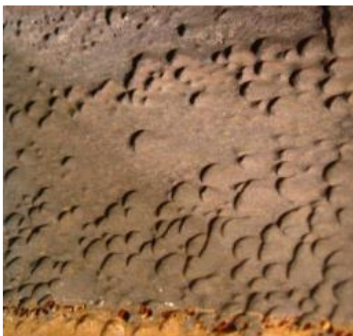
Slika 16 Udarni napad u obliku kopita [10]
