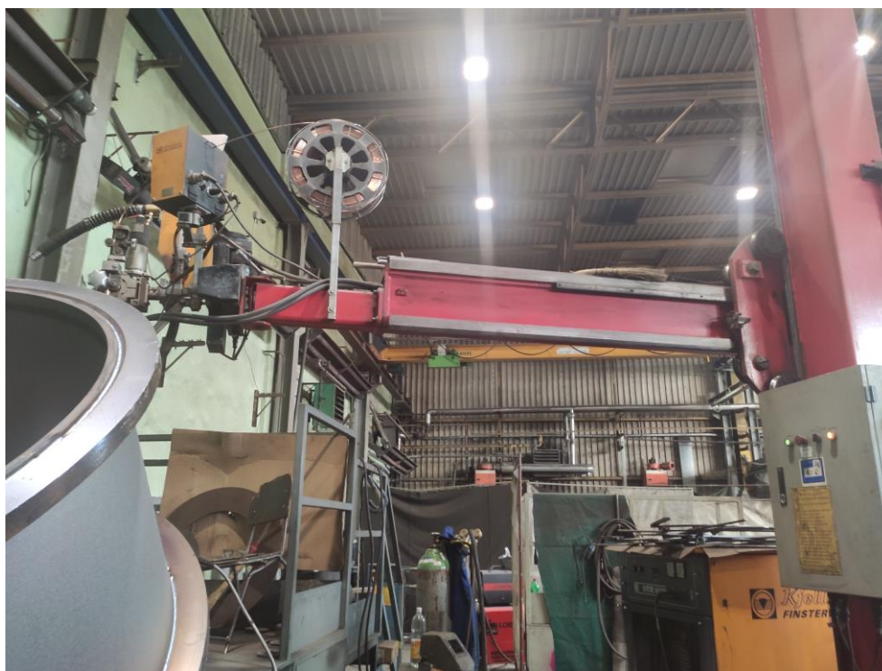
Slika 54 Ruka sa pištoljem za EPP zavarivanje
