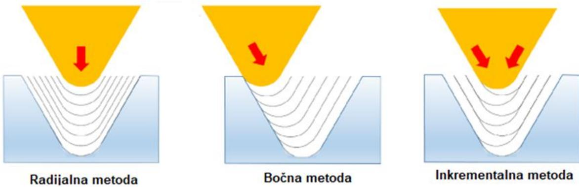
*Slika 15 - Metode ulaska rezne pločice u zahvat [13]*
