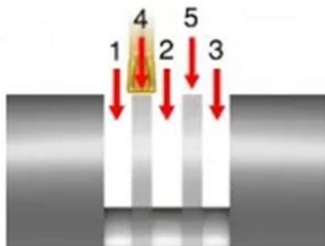
Slika 10 - Metoda s više radijalnih ureza [11]
