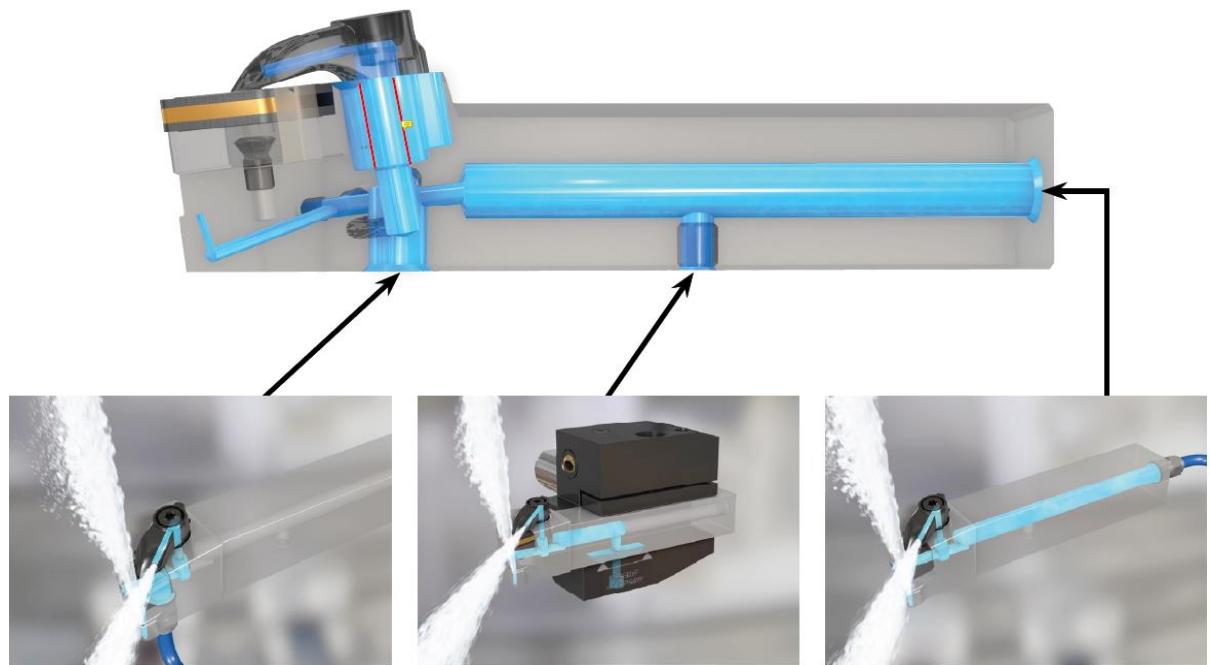
*Slika 25 - Alati sa polijevanjem na vrh pločice [27]*
