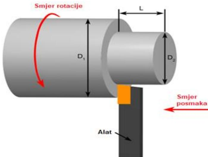
Slika 2 - Longitudinalno tokarenje [4]
