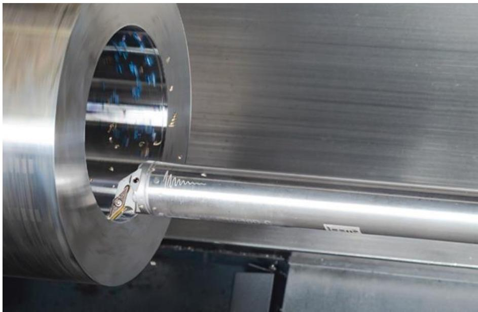
Slika 6 - Unutarnje tokarenje [7]
