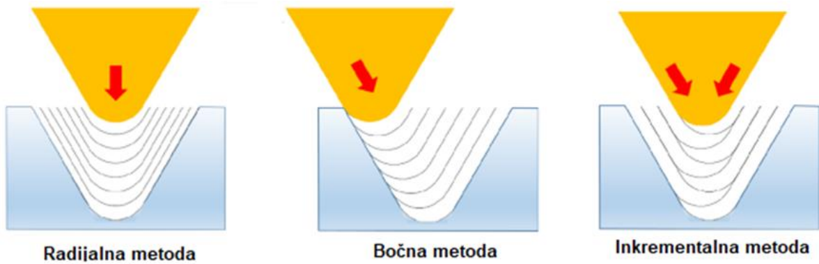
Slika 15 - Metode ulaska rezne pločice u zahvat [13]
