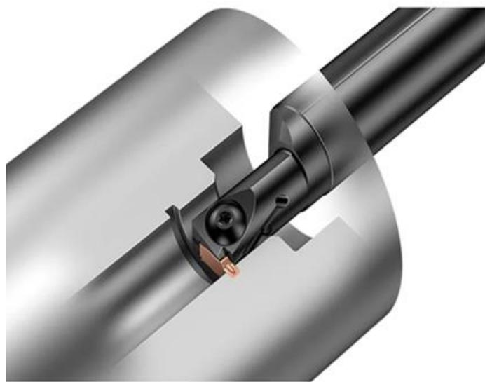
Slika 14 - Alati za unutarnje urezivanje [12]
