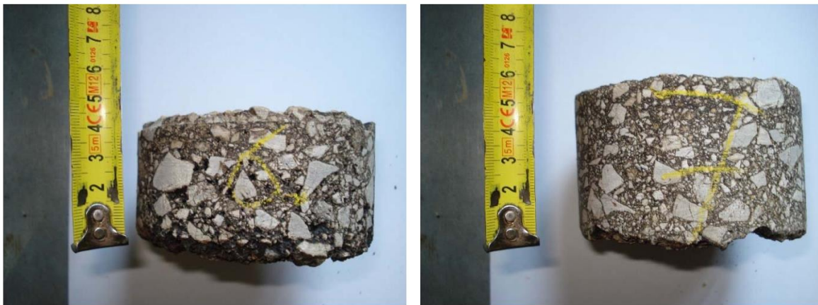
Slika 19. Ispitivanje debljine nosivog sloja (ŽC 3257)
