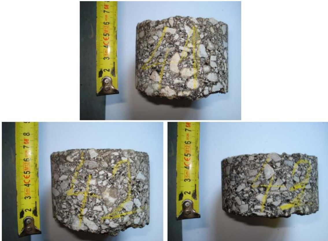
Slika 7. Ispitivanje debljine nosivog sloja (LC 34059)
