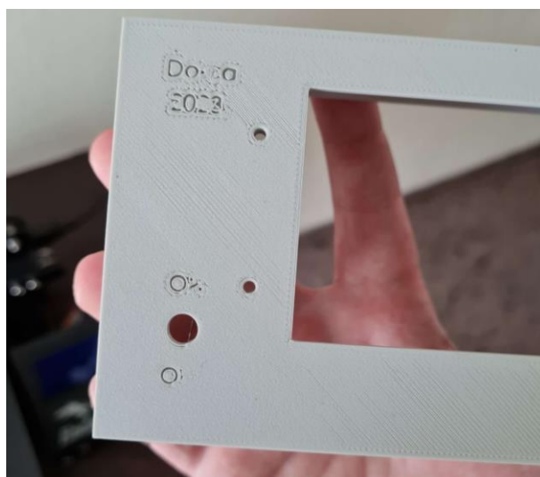
Slika 6.2. – prednji dio kućišta, isprintan
