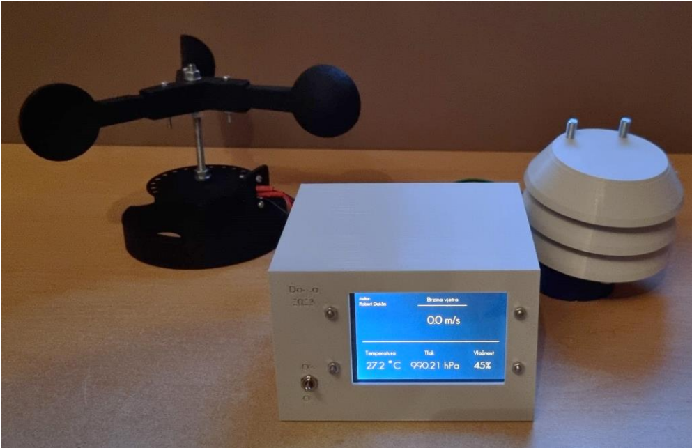
Slika 7.1. – prikaz izrađene meteorološke stanice
