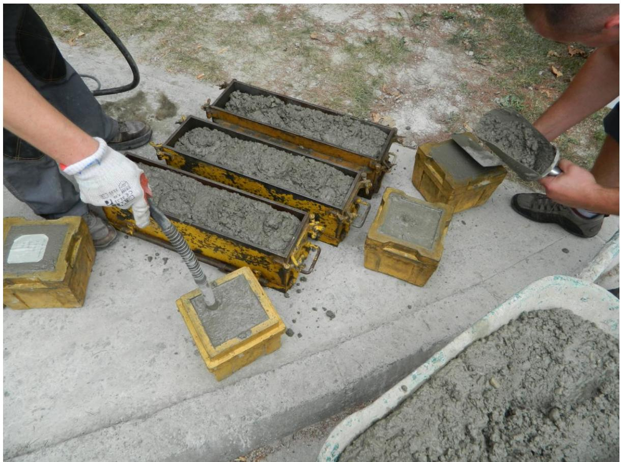
*Slika 21 Betoniranje modela betonskih prizmi*
