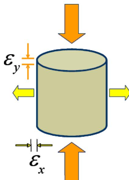
Slika 13 Pravokutni uzorak opterećen na pritisak, Poissonov omjer  $v \sim 0,5$  (guma)
