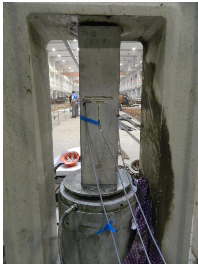
Slika 22 Ispitivanje tlačne čvrstoće betona
