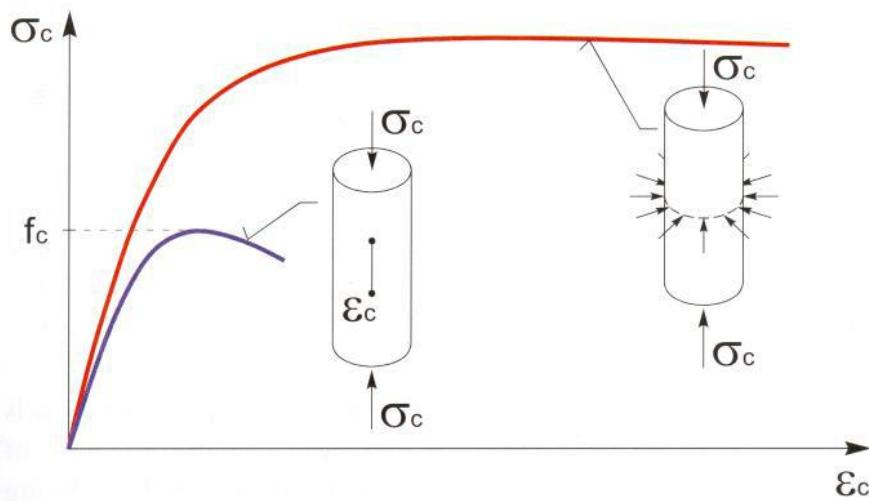
Slika 10 Efekt poprečnog tlaka na dijagramu naprezanje-deformacija betona
