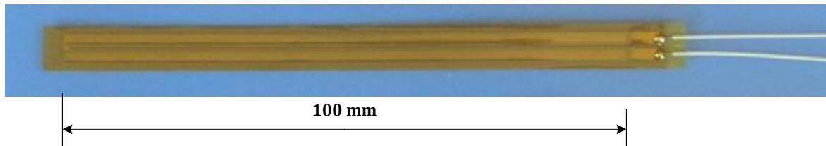
Tenzometar 6/120 LY41, mjernog otpora 120Ω za beton
