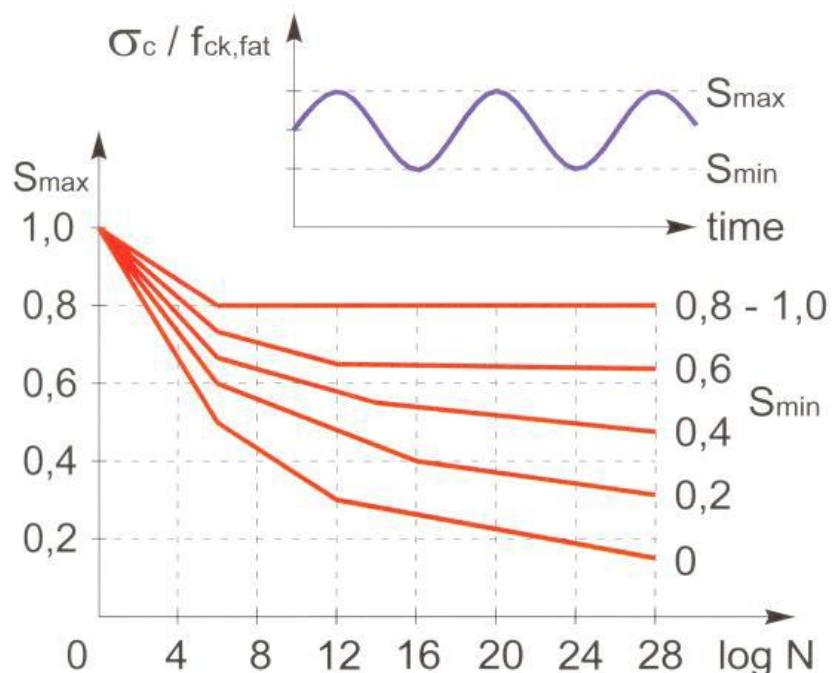
Slika 8 S-N krivulje za beton opterećen na tlak
