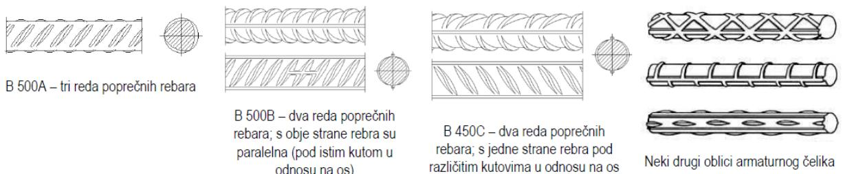
Slika 3 Oblici armaturnog čelika
