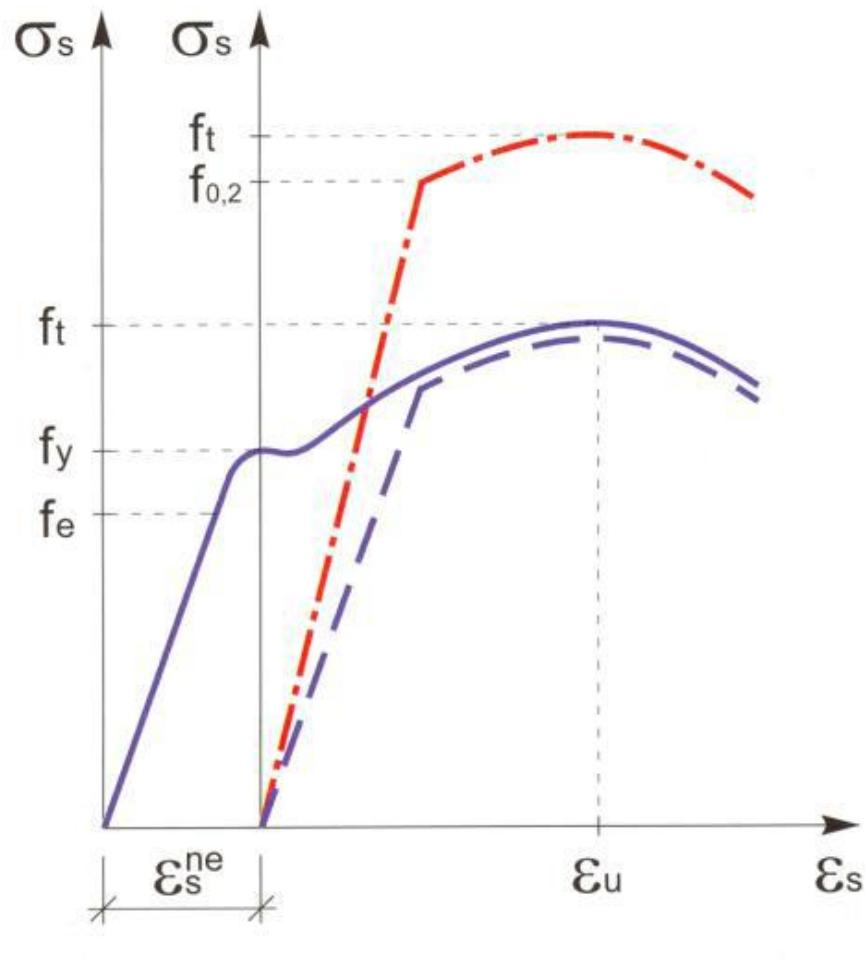
Slika 1 Radni dijagram čelika za armiranje
