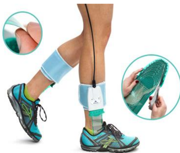
Slika 8: Prikaz F-scan uloška i primjenu istog
