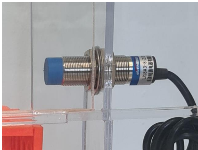
Slika 2.10: Korišteni induktivni senzor, NO
