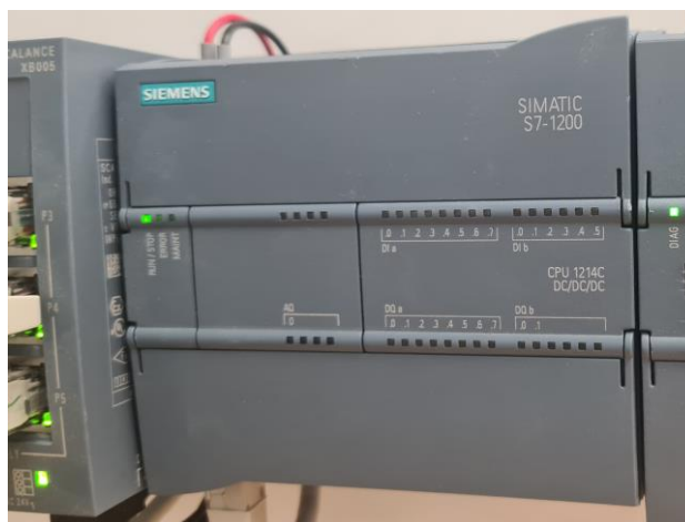
Slika 2.4: Korišteni PLC S7-1200
