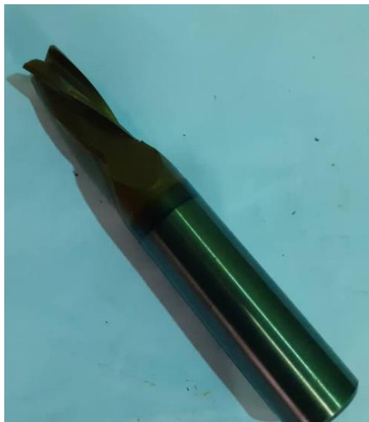
Slika 4. Tvrdometalno glodalo za finu obradu
