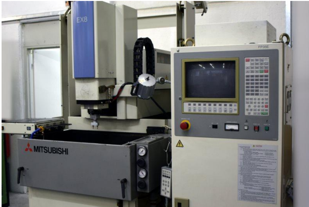
Slika 25. Stroj za graviranje pomoću erozije (TM Čakovec)
