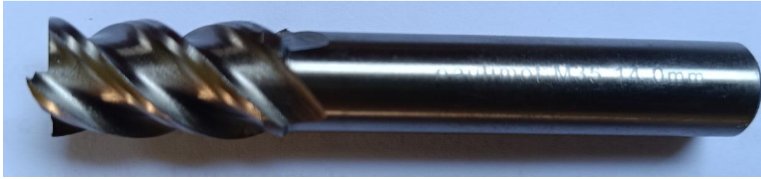
Slika 3. Glodalo od brzoreznog čelika
