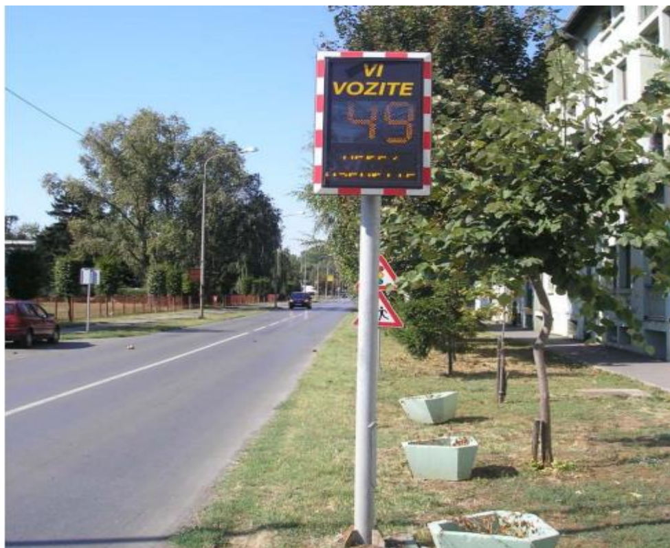
Slika 3-14 - Smirivanje prometa uređajem za određivanje brzine vožnje
